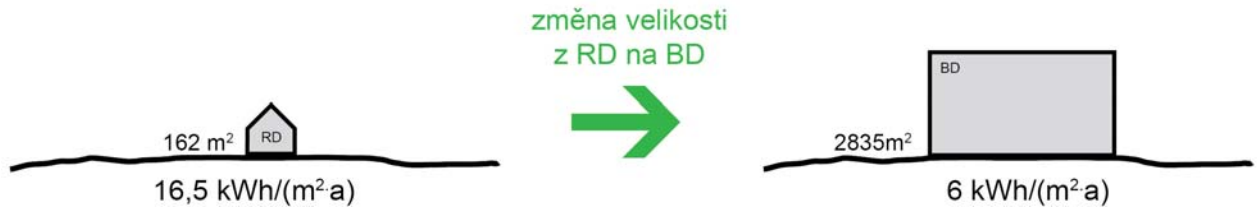
obr. 5.1 Schematické znázornění velikosti stavby RD a BD
