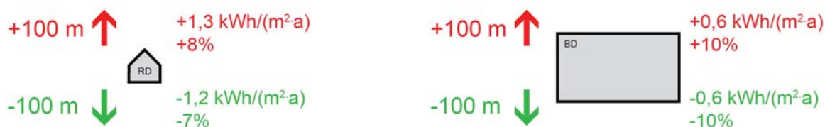
obr. 4.3 Schematické znázornění vlivu korekce nadmořské výšky na RD a BD
