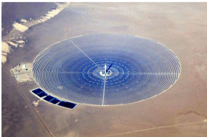
Obr. 5.8: Solární elektrárna – heliostaty s věží uprostřed [24].
