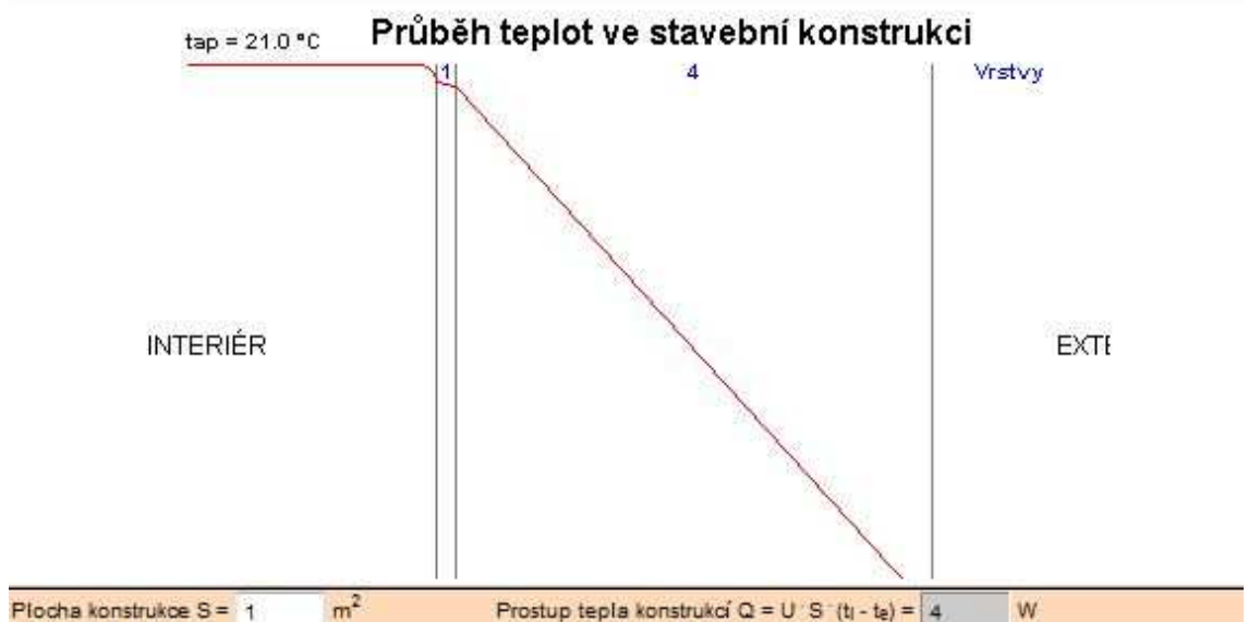
Obr. č. 27 Výpočet součinitele prostupu tepla – stropní kce v 2.N.P (TZB-info.cz, 2013a)
