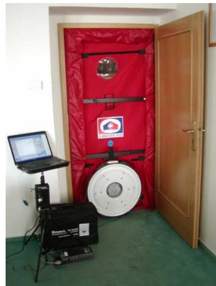
Obr. č. 9 Blower-Door test (CIUR, 2013)
