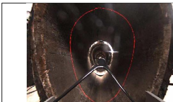
Obr. 7.8 Skutečný snímek měření profilu pomocí laseru ze záznamu kamerou [48]
