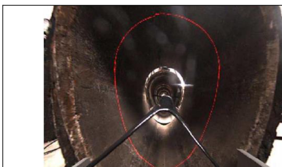
Obr. 7.8 Skutečný snímek měření profilu pomocí laseru ze záznamu kamerou [48]
