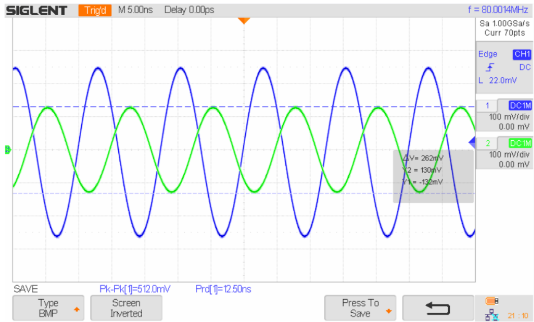
Obrázek 10.14: Signál z generátoru a z atenuátoru
