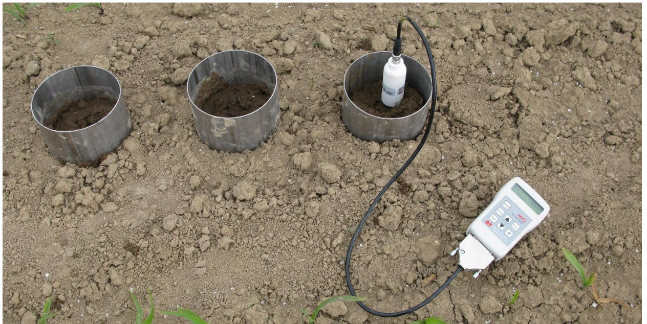
Obr. 4 - Měření hydraulické vodivosti
