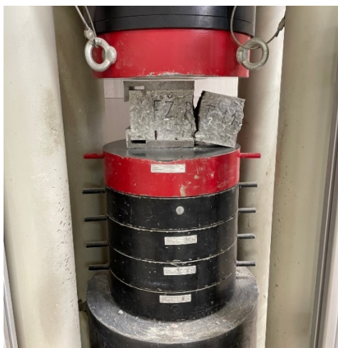
Obrázek 21: Zkouška pevnosti v tlaku na zlomku trámce
