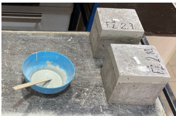
Obrázek 17: Aplikace ochranného nátěru na vzorky krychlí
