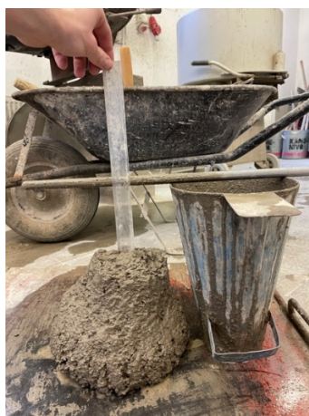
Obrázek 24: Zkouška sednutí kužele
