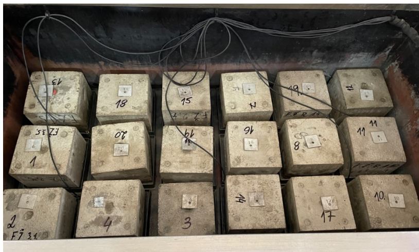
Obrázek 22: Zkušební tělesa uvnitř mrazícího boxu
