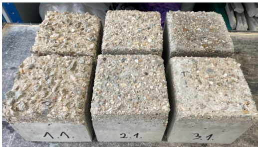
Obrázek 33: Tělesa uložená ve vodním prostředí
