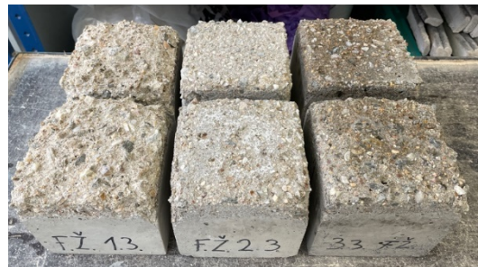
Obrázek 32: Tělesa uložená ve vlhkém prostředí
