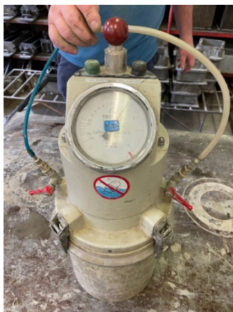
Obrázek 25: Zkouška obsahu vzduchu – tlaková metoda
