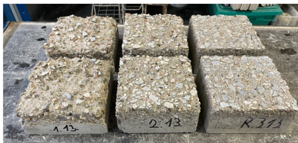
Obrázek 34: Řezy krychlí ošetřované ve vodním prostředí
