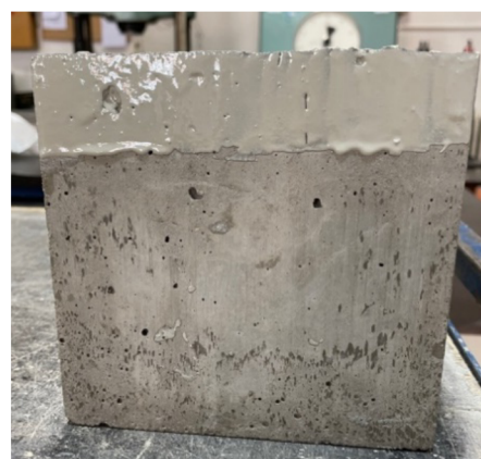
Obrázek 18: Ochranný nátěr kolem bočních ploch vzorku
