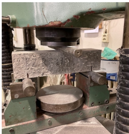
Obrázek 20: Zkouška pevnosti v tahu ohybem jedním břemenem uprostřed
