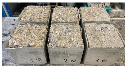
Obrázek 35: Tělesa uložená ve vodním prostředí s ochranným nátěrem
