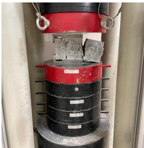
Obrázek 21: Zkouška pevnosti v tlaku na zlomku trámce
