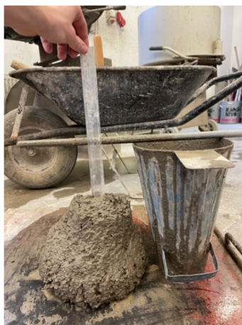
Obrázek 24: Zkouška sednutí kužele
