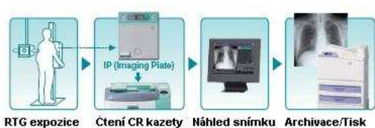
Obr. 3 Cyklus obrazu zachyceného na paměťovou fólii
