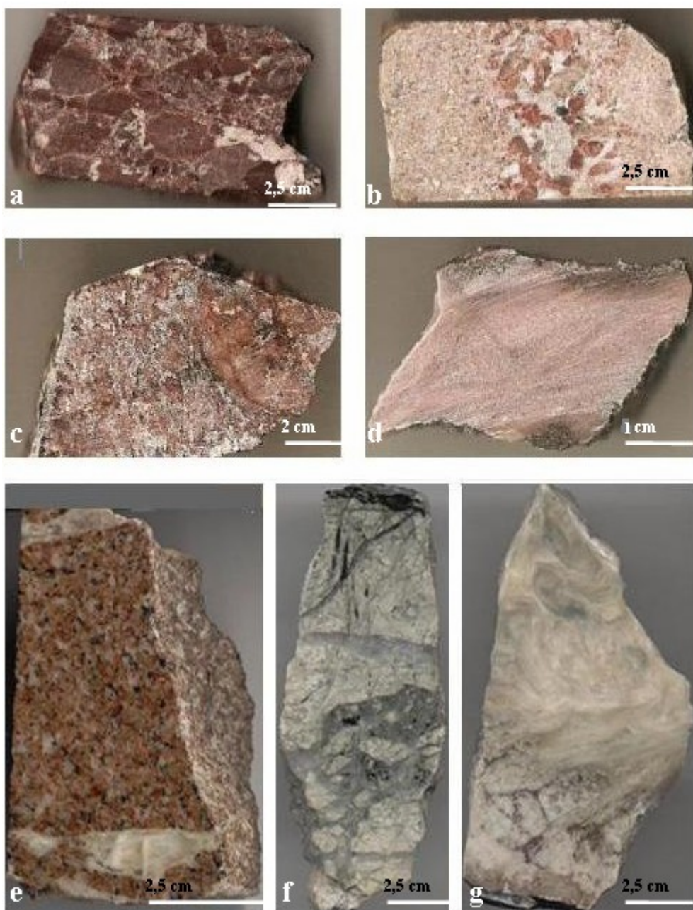
Obr. 3. Studované vzorky z lokality Okrouhlá Radouň; a) Hrubozrný episyenit (Se-1) tmavě hnědočervené barvy; b) Středně až jemně zrnitý episyenit (DOR-3b); c) Střednězrnitý episyenit (NO-8060); d) Střednězrnitý episyenit s žilkou (NO-8098); e) Ostrohranný úlomek kalcitové žíly s horninou (dioritový porfyrit), Pa-119; f) Brekcie granitu (Re-720) s křemennými žilkami; g) Ostrohranný úlomek kalcitové žíly (NO-8037a).
