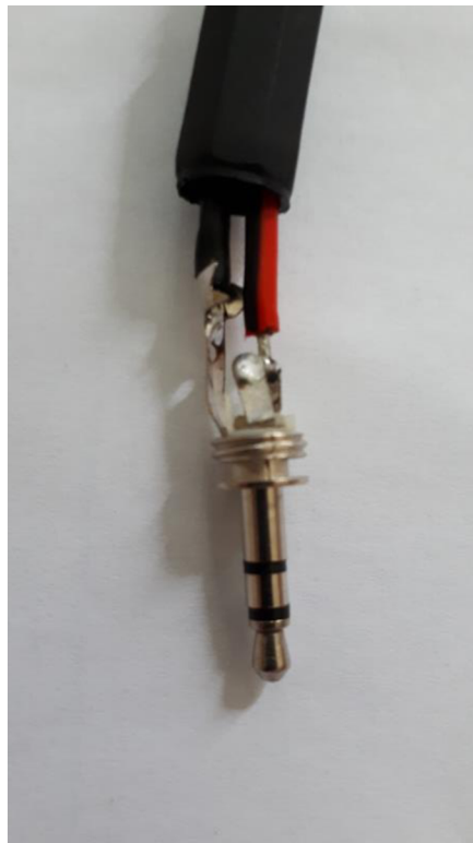
Obrázok 6-3 Zapojenie 3,5mm jacku na strane prijímača
