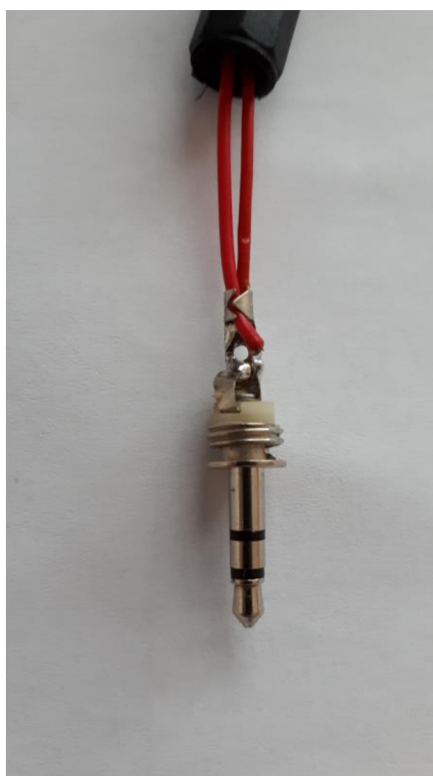
Obrázok 6-1 Zapojenie 3,5mm jacku na strane vysielča
