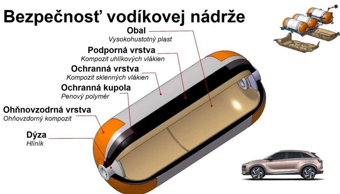
Obr. 33 - Zloženie vodíkovej nádrže pre Hyundai Nexu [119]
