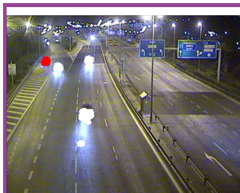
Obr.č. 28: Záznam detekce kolon a stojícího vozidla - 6 obrázků [8]
