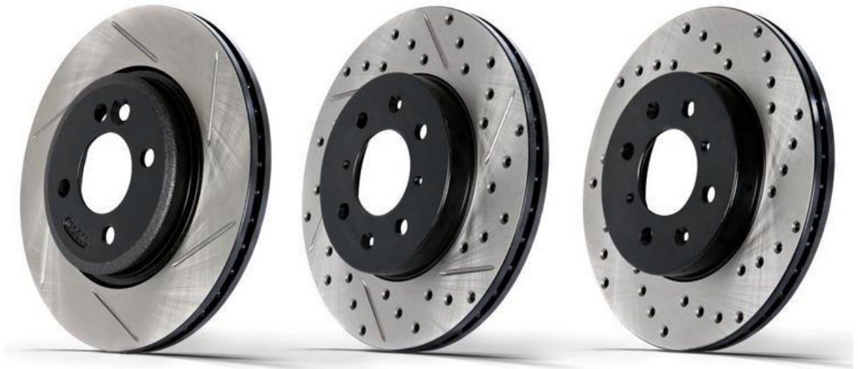
Obr. 11: Brzdové kotouče pro sportovní vozy s prvky zlepšující jejich vlastnosti. [14]
