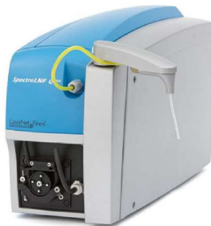
Obrázek 4.6 Čítač částic Spectro LNF Q200 (spectro.cz [b.r.])
