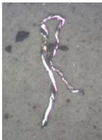
Obrázek 3.10 Částice abrazivního opotřebení (Fitch a Noria Corporation 2013)
