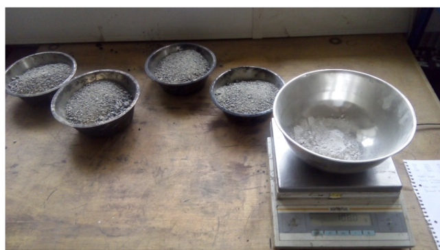
Obr. 21 Přesné navážení frakce a fillerů
