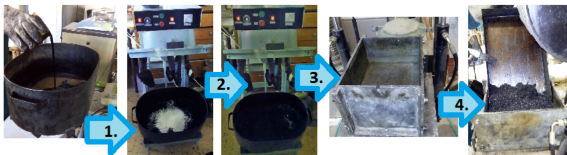
Obr. 28 Vsypání asfaltové směsi do zhutňovače
