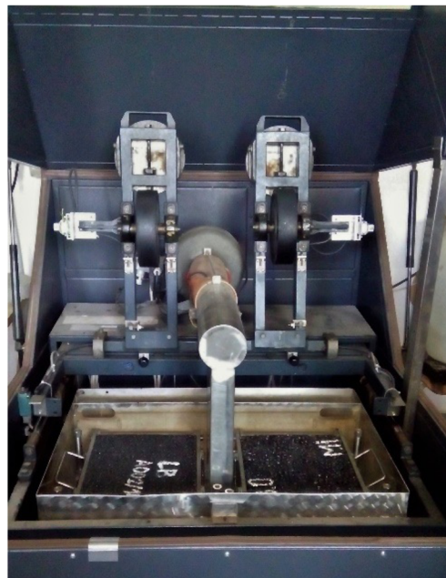
Obr. 31 Příklad přístroje na vyjetí kolejí
