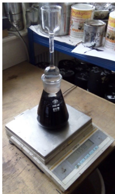
Obr. 25 Tvar a popis pyknometru
