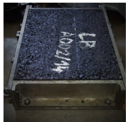
Obr. 32 Uchycení desky ve formě
