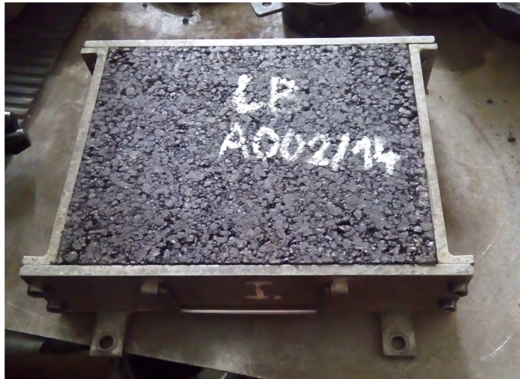
Obr. 33 Deska před zkouškou pojezd kolem
