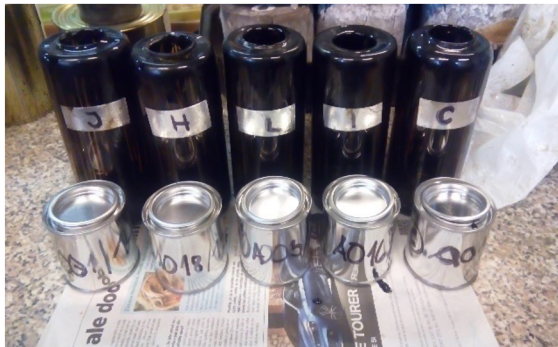
Obr. 7 Skleněné nádoby po metodě RTFOT
