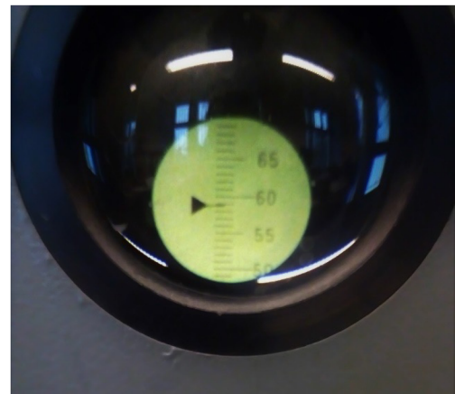
Obr. 9 Vpich jehly do vzorku (vlevo), stupnice penetrometru (vpravo)
