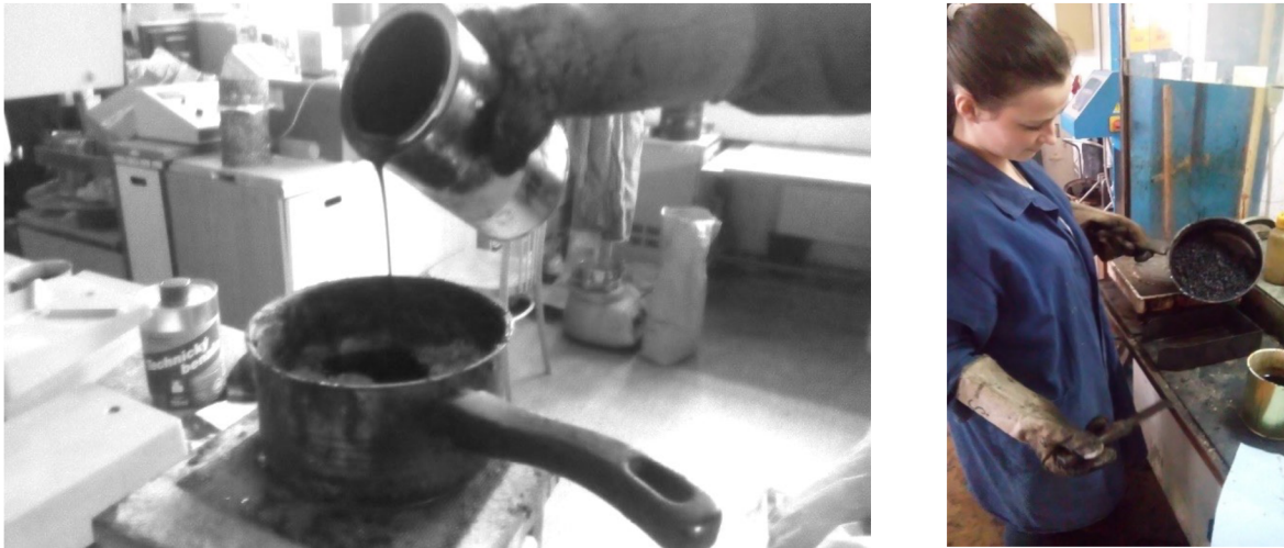
Obr. 22 Obalování zrn asfaltovým pojivem
