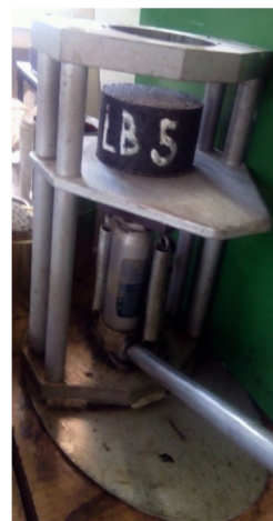
Obr. 24 Marshall tělesa (vlevo), lis s Marshallovým tělesem (vpravo)
