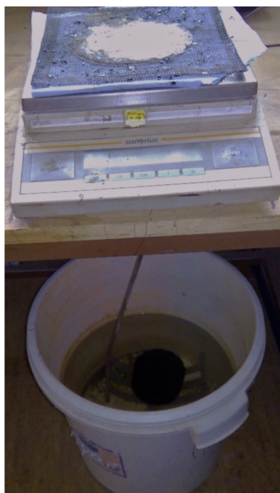
Obr. 27 Marshallové těleso ponořené ve vodní lázni
