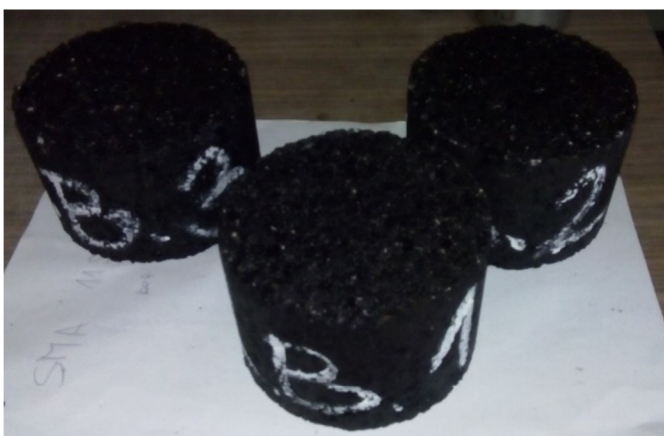
Obr. 24 Marshall tělesa (vlevo), lis s Marshallovým tělesem (vpravo)
