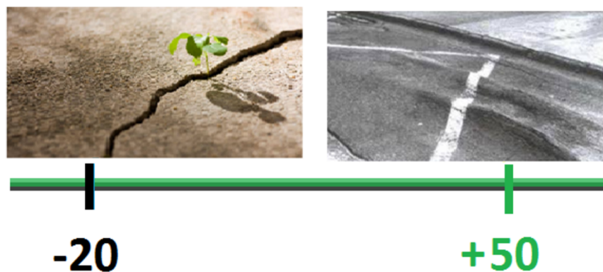
Obr. 2 Vymezení oboru použitelnosti asfaltu na teplotní ose 1
