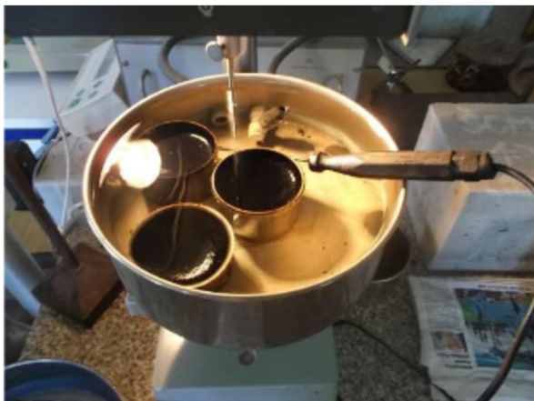
Obr. 9 Vpich jehly do vzorku (vlevo), stupnice penetrometru (vpravo)
