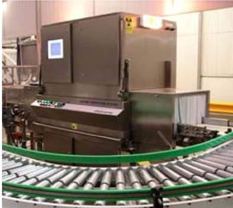
Obr. č. 8 Röntgenové zariadenie pre kontrolu výrobkov [21]
