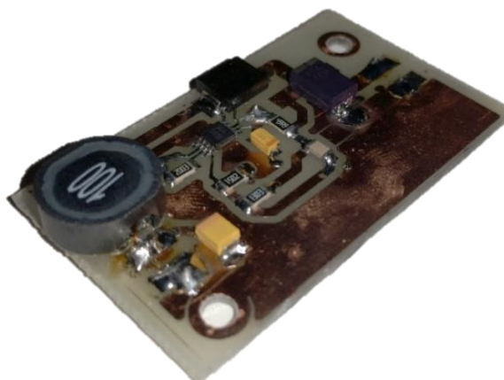
Obr. 37 LMR61428 - Reálná deska plošného spoje včetně součástek
