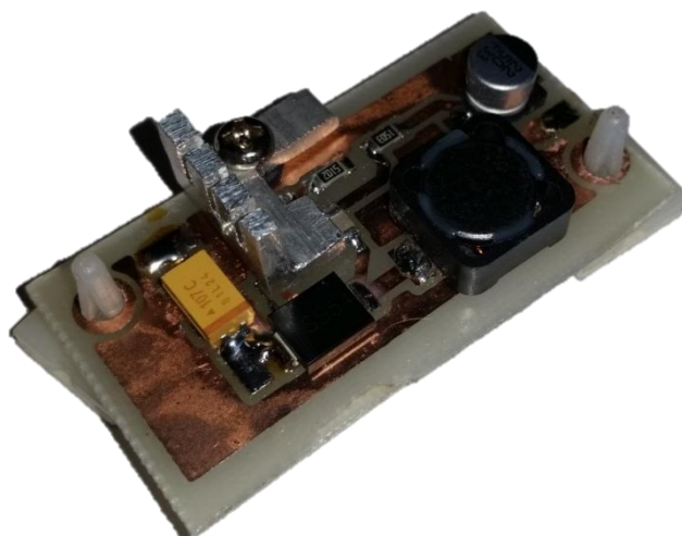
Obr. 40 LM2623 - Reálná deska plošného spoje včetně součástek
