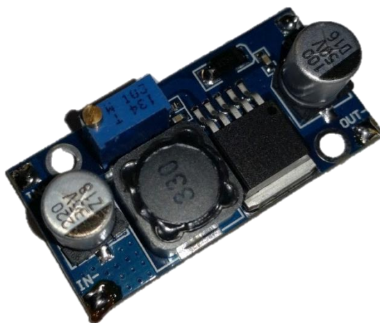
Obr. 42 XL6009 - Reálná deska plošného spoje včetně součástek
