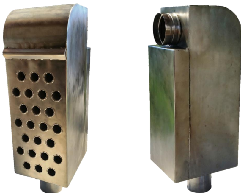
Obr. 50 Reálná podoba navrženého tepelného výměníku
