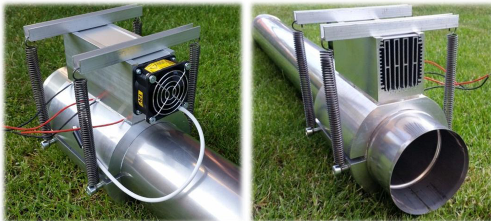
Obr. 51 Reálná podoba soustavy TEG, chladiče a mezikusu na kouřovodu
