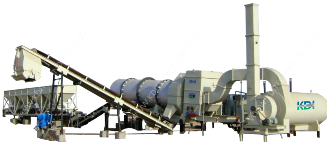
Obrázek 20: Schéma kontinuální obalovny [4]
