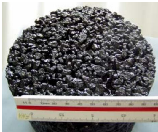
Obrázek 7: Gyrátorem zhutněné těleso SMA NR 8 (Dánsko) [82]
