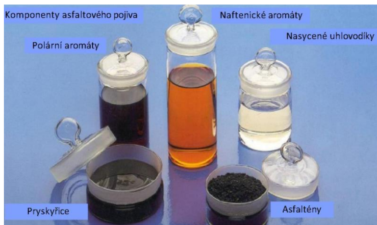
Obrázek 14: Jednotlivé komponenty asfaltového pojiva [136]
