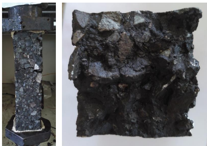
Obrázek 61: Směs 1-2 detail porušení tělesa vlivem působení kryogenního napětí
