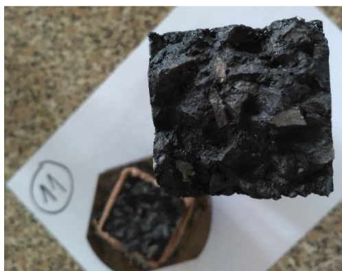
Obrázek 62: Směs 11 detail porušení tělesa vlivem působení kryogenního napětí
