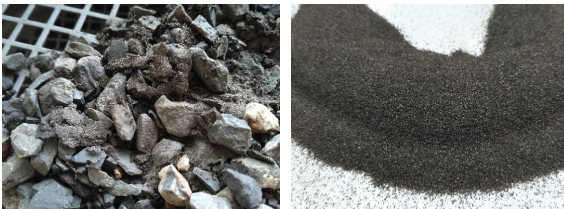
Obrázek 57: Směs 16 – síť 8 a 0,125, lze vidět obsažený pryžový granulát
