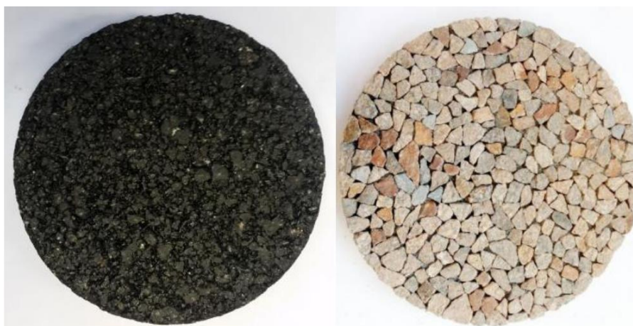
Obrázek 13: Zkušební tělesa pro zkoušku dle ČSN EN 12697-49 [9, 38]
