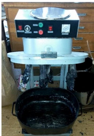
Obrázek 27: Míhací zařízení pro laboratorní výrobu asfaltové směsi [77]
