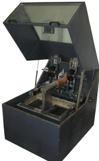
Obrázek 30: Zařízení na zkoušku pojíždění kolem [16]
