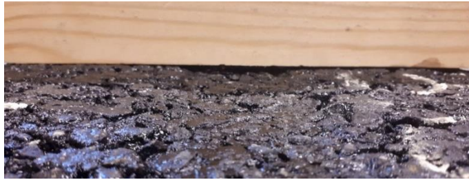
Obrázek 58: Detail vyjeté koleje zkušebního tělesa směsi 13
