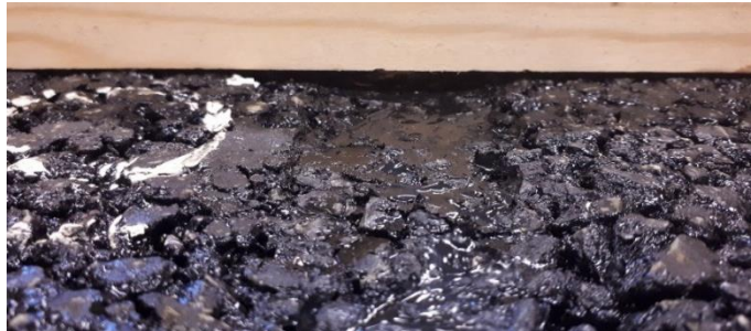
Obrázek 59: Detail vyjeté koleje zkušebního tělesa směsi 10
