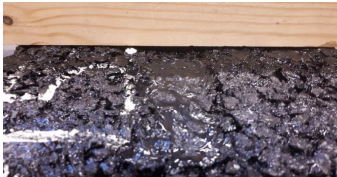
Obrázek 60: Detail vyjeté koleje zkušebního tělesa směsi 15
