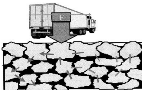
Obrázek 4: Přenos zatížení dopravou směsí SMA pomocí kontaktních bodů v kostře kameniva [98]
