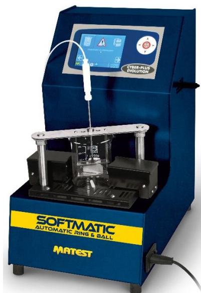
Obrázek 34: Příklad na stanovení bodu měknutí metodou KK [8]
