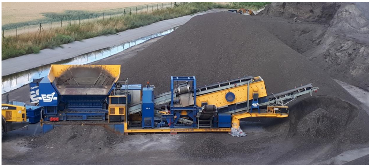
Obrázek 23: Granulátor na obalovně u Perzendorf v Rakousku
