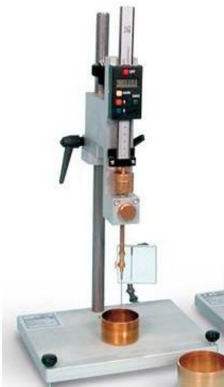
Obrázek 33: Příklad na stanovení penetrace jehlou [86]
