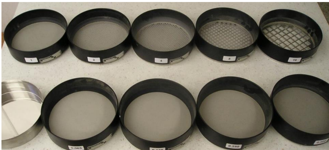
Obrázek 25: Sada sít pro stanovení zrnitosti [100]
