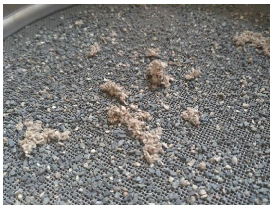
Obrázek 56: Směs 5 - síť frakce 1 mm, lze vidět obsažené celulózové vlákno
