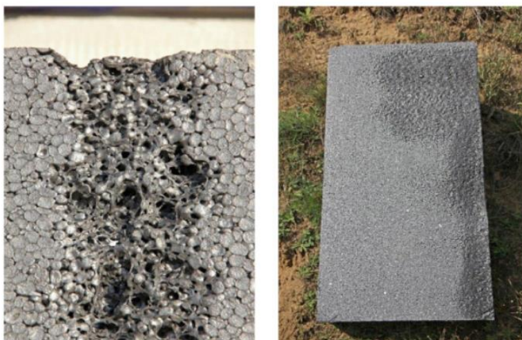
Obrázek 13: Povrch grafitového polystyrenu narušený vlivem slunečního záření [33]
