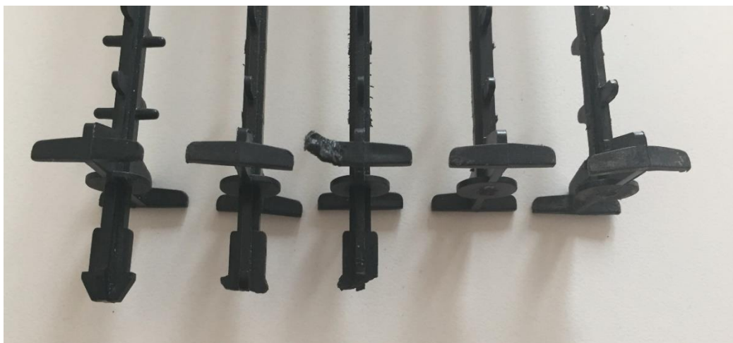
Obrázek 62: Místa porušení plastových spojek při stanovování síly potřebné k porušení
