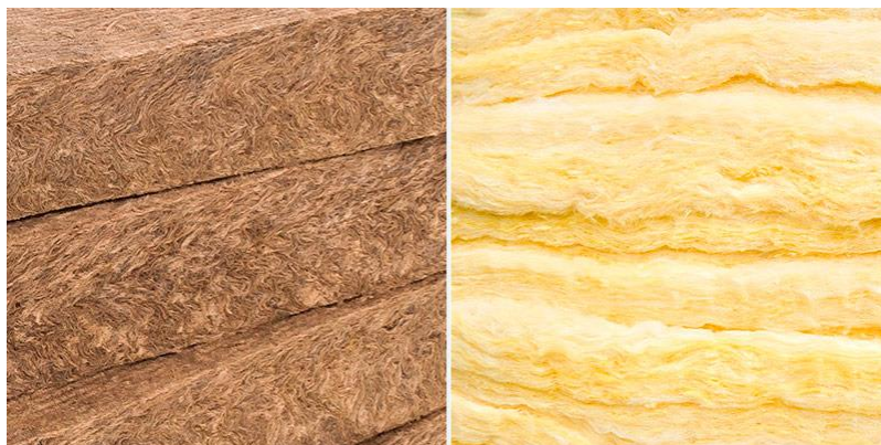
Obrázek 20: Minerální vlna - kamenná (vlevo), skelná (vpravo) [42]
