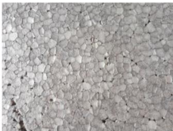
Obrázek 11: Expandovaný pěnový polystyren s přídavkem grafitu [33]
