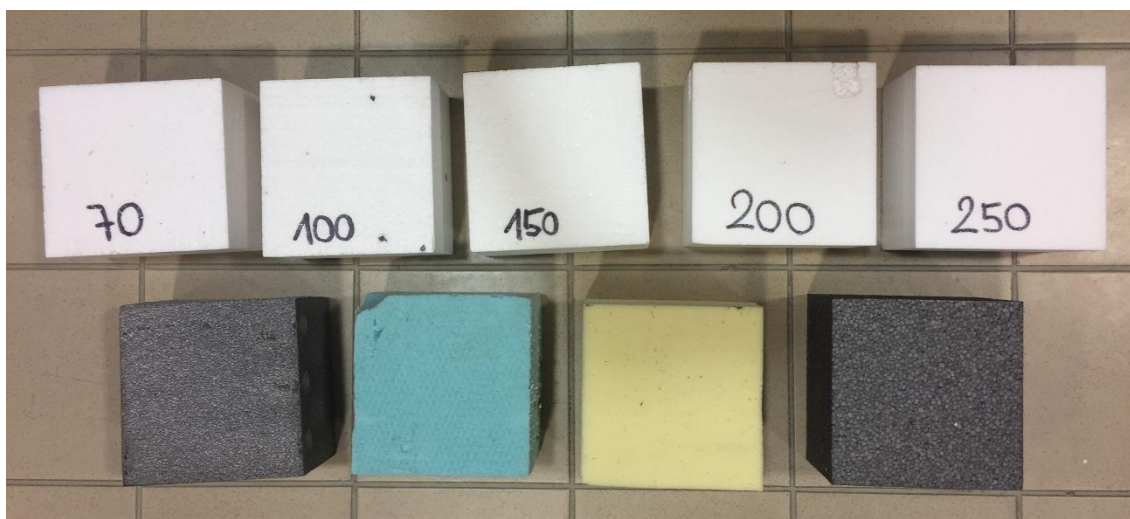
Obrázek 46: Vzorčky tepelných izolantů připravené ke zkoušce pevnosti v tlaku při 10% deformaci
