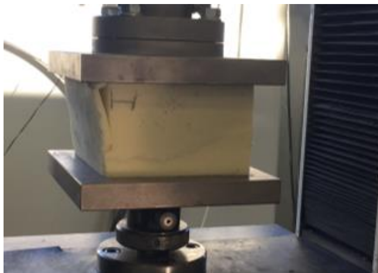
Obrázek 47: Porušení při stanovování pevnosti v tlaku před dosažením 10% deformace PUR
