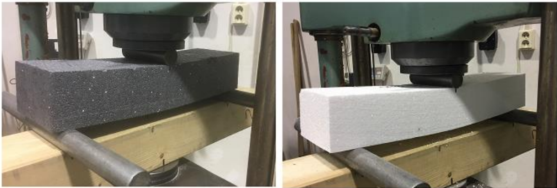
Obrázek 49: Tepelné izolanty při zkoušce pevnosti v tahu za ohybu; vlevo – PERIMETR, vpravo – PUR
