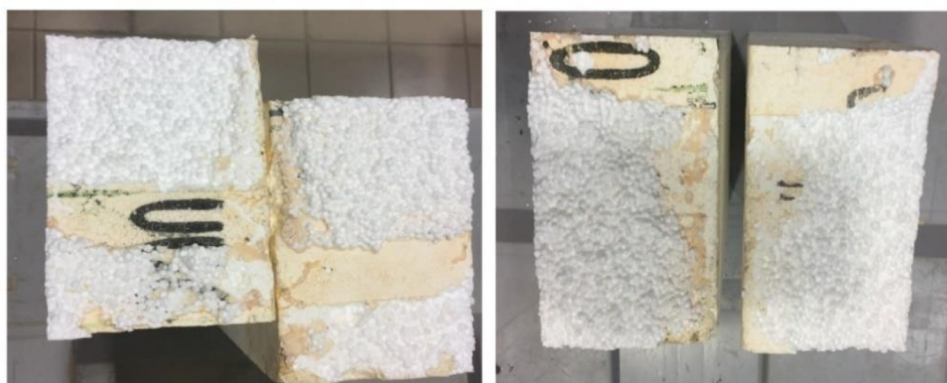
Obrázek 57: Míra a místa porušení u lepených spojů EPS 250 po stanovení pevnosti v tahu za ohybu:
