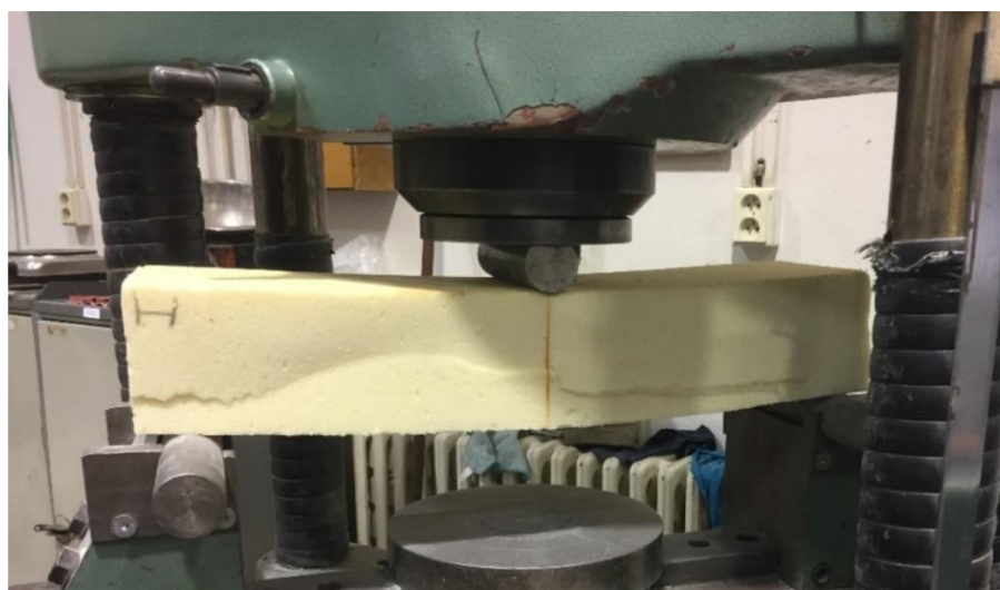
Obrázek 55: Působení ohybového zatížení na lepený vzorek PUR
