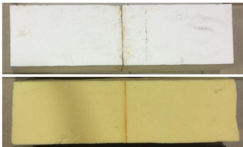
Obrázek 54: Zkušební vzorky tepelných izolantů na zkoušku pevnosti v tahu za ohybu lepeného spoje
