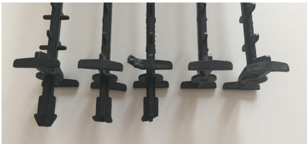
Obrázek 62: Místa porušení plastových spojek při stanovení síly potřebné k porušení
