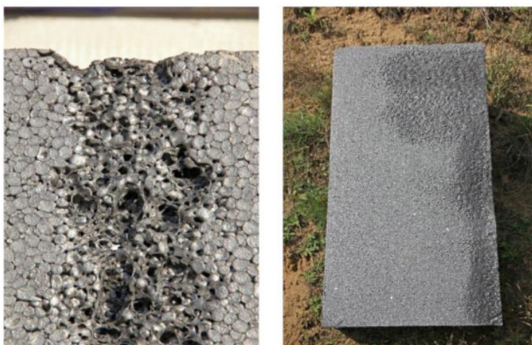
Obrázek 13: Povrch grafitového polystyrenu narušený vlivem slunečního záření [33]
