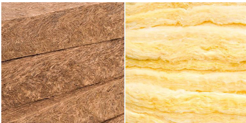
Obrázek 20: Minerální vlna - kamenná (vlevo), skelná (vpravo) [42]
