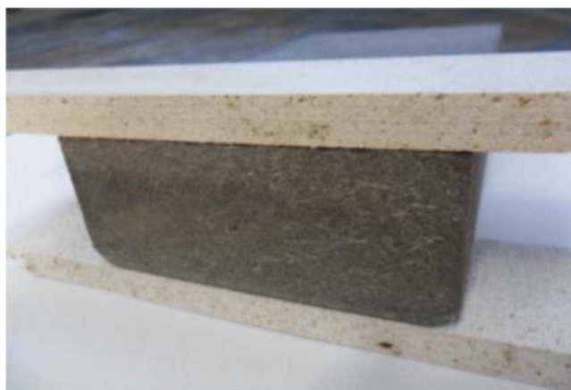
Obrázek 19: Tuhý PUR mezi hořečnatými deskami vyztuženými skelnými vlákny [70]
