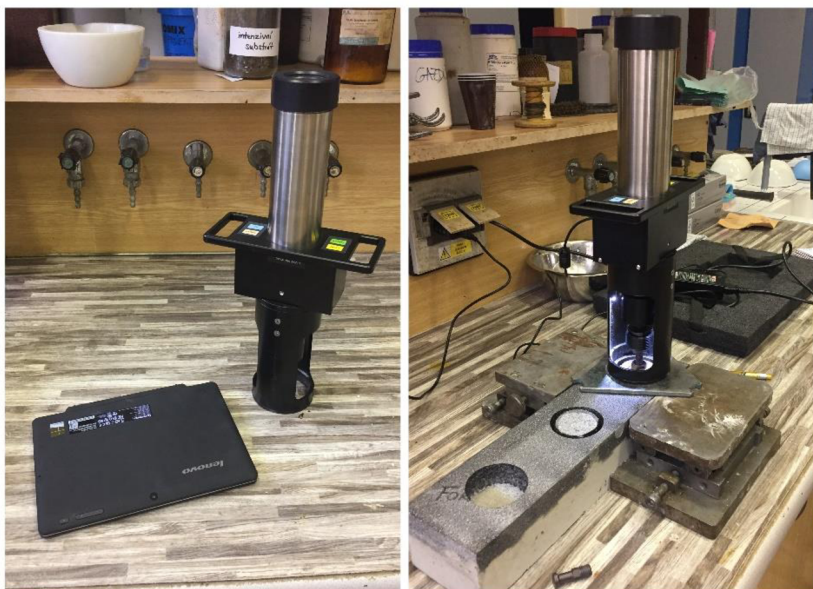
Obrázek 44: Odtrhový přístroj pro stanovení přídržnosti tepelného izolantu k betonu
