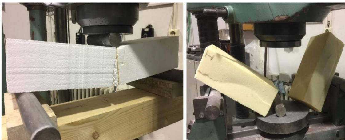
Obrázek 56: Místa porušení při působení zatěžovacího břemena při stanovení tahu za ohybu: EPS 250 (vlevo); vpravo PUR (vpravo)
