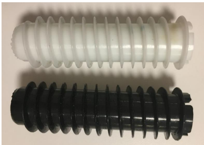
Obrázek 58: Plastové hmoždiny zkoušené k použití do ICF systému
