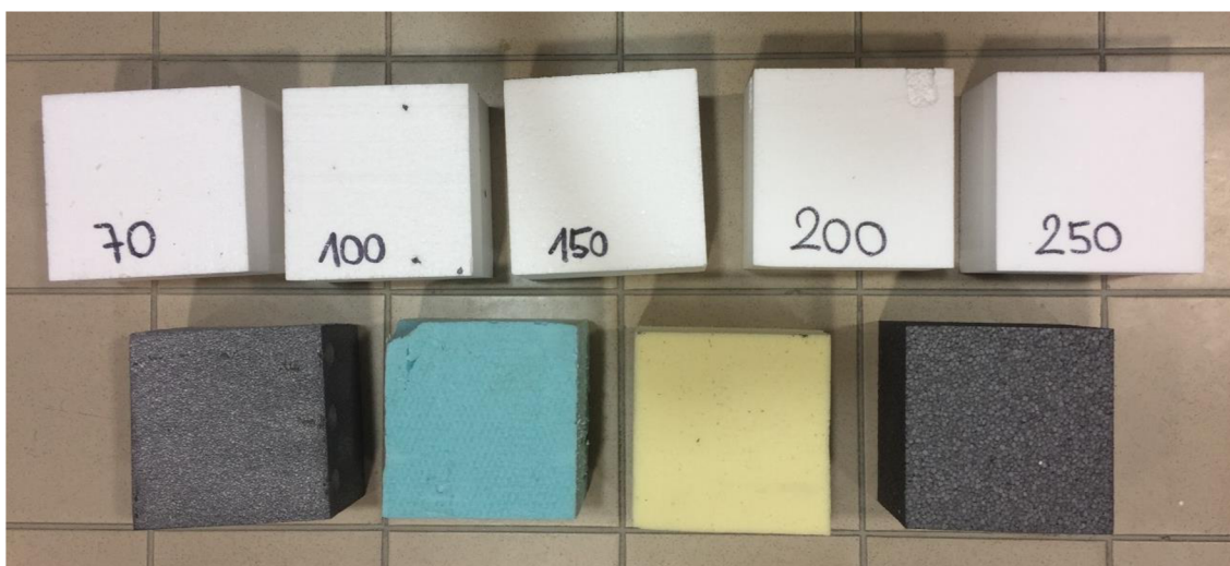
Obrázek 46: Vzorky tepelných izolantů připravené ke zkoušce pevnosti v tlaku při 10% deformaci
