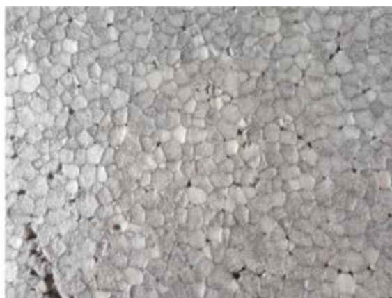
Obrázek 11: Expandovaný pěnový polystyren s přídavkem grafitu [33]
