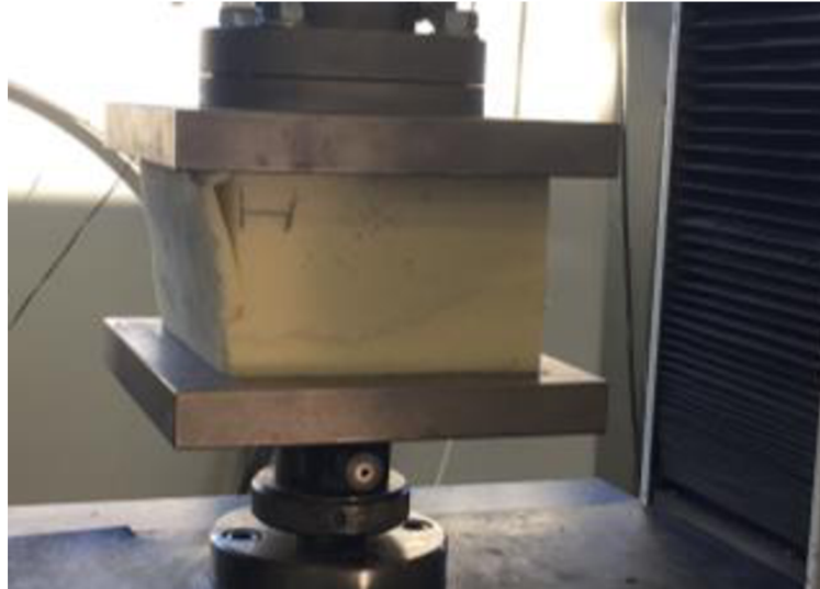
Obrázek 47: Porušení při stanovování pevnosti v tlaku před dosažením 10% deformace PUR
