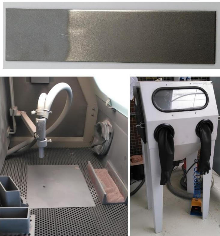
Obr. 15 Upravený povrch adherendu v tryskací komoře
