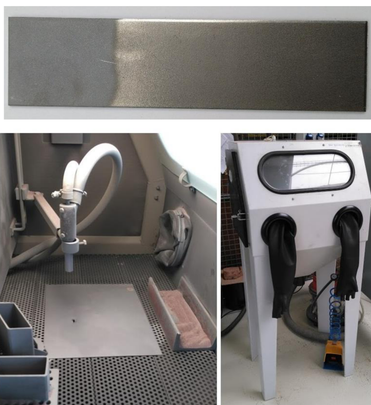
Obr. 15 Upravený povrch adherendu v tryskací komoře
