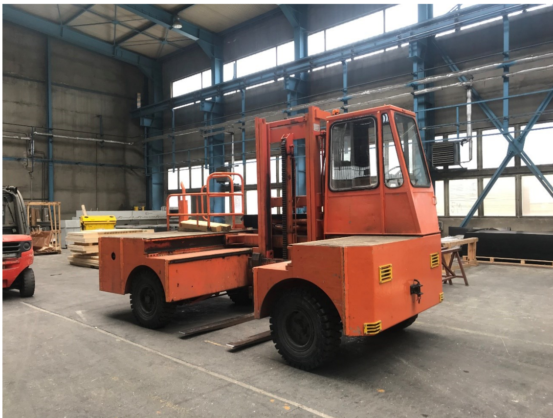
Obr. 2.8 Boční nakladač používaný ve společnosti MS
