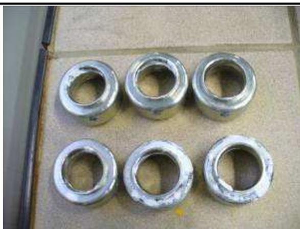
Testované díly – viditelná bílá koroze
