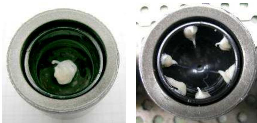
Obr.č. 17: nanášení mazacího tuku při montáži
