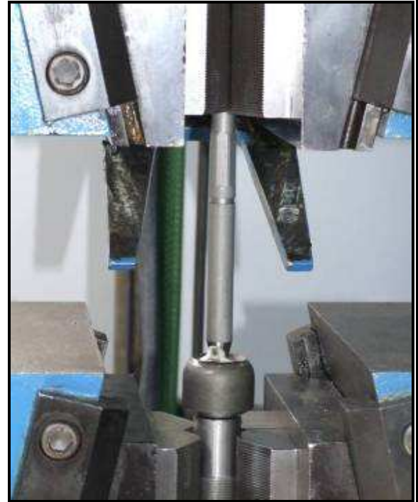
Obr. č. 7 – test vytržení
