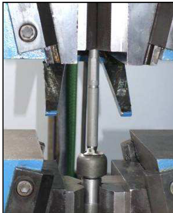
Obr. č. 7 – test vytržení
