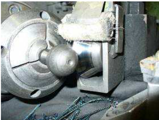
Obr. 11 a 12. Koule čepu před a po obráběcí operaci
