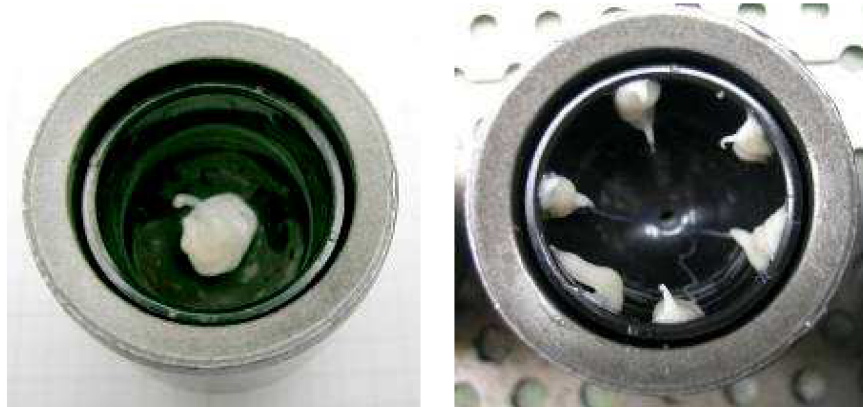
Obr.č. 17: nanášení mazacího tuku při montáži
