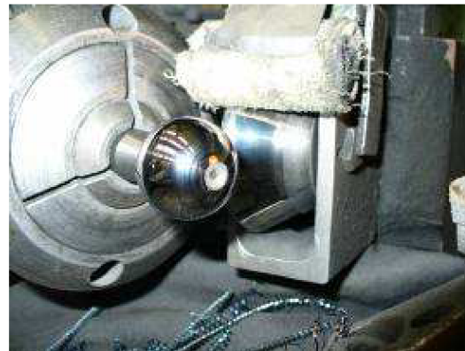
Obr. 11 a 12. Koule čepu před a po obráběcí operaci
