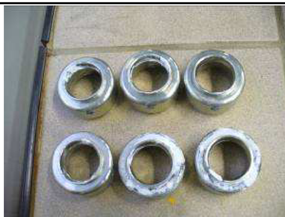
Testované díly – viditelná bílá koroze
