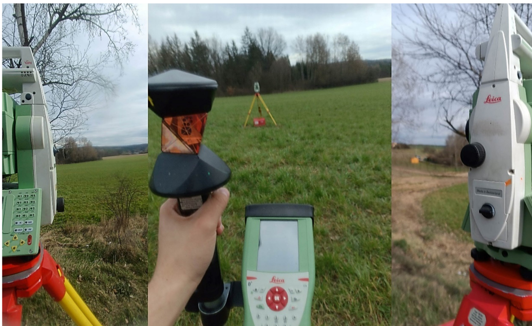
Obrázek 2.5 Doměření bodů totální stanicí (Plic, 2022)
