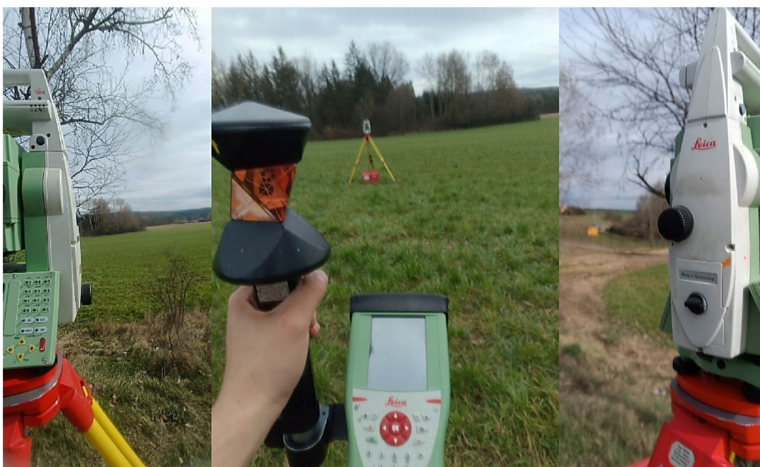
Obrázek 2.5 Doměření bodů totální stanicí (Plíc, 2022)
