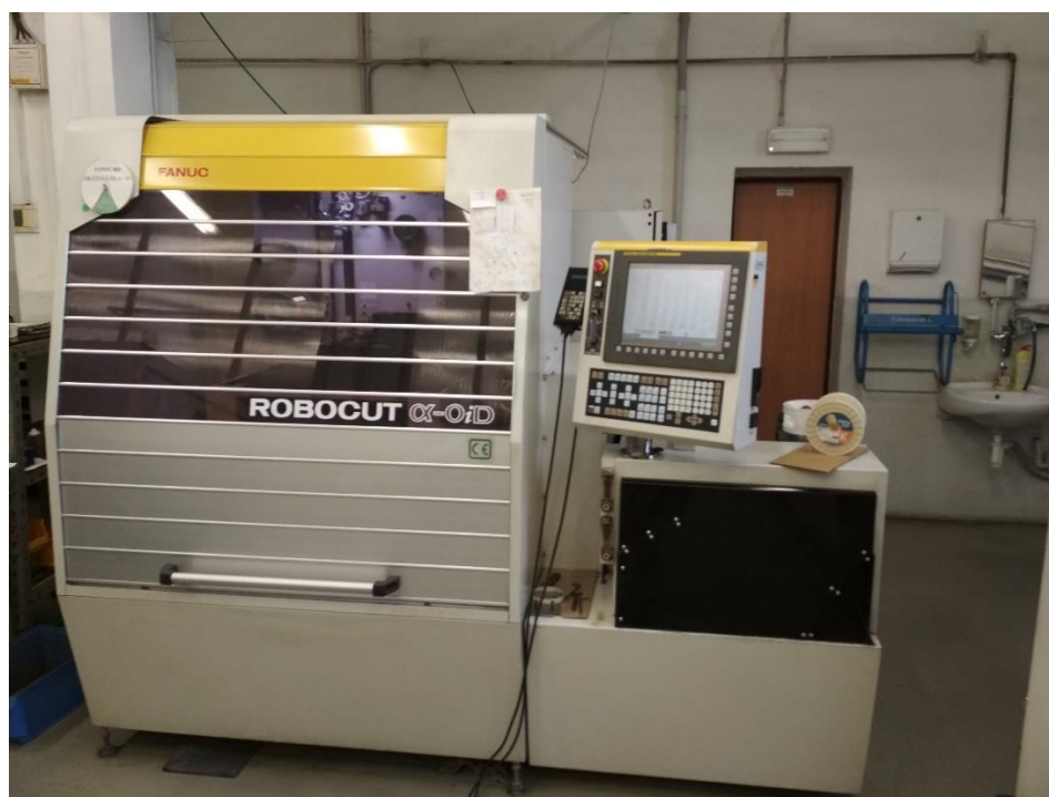
Obr. 52 Drátová řezačka ROBOCUT \alpha -0iD od firmy Fanuc, s.r.o.
