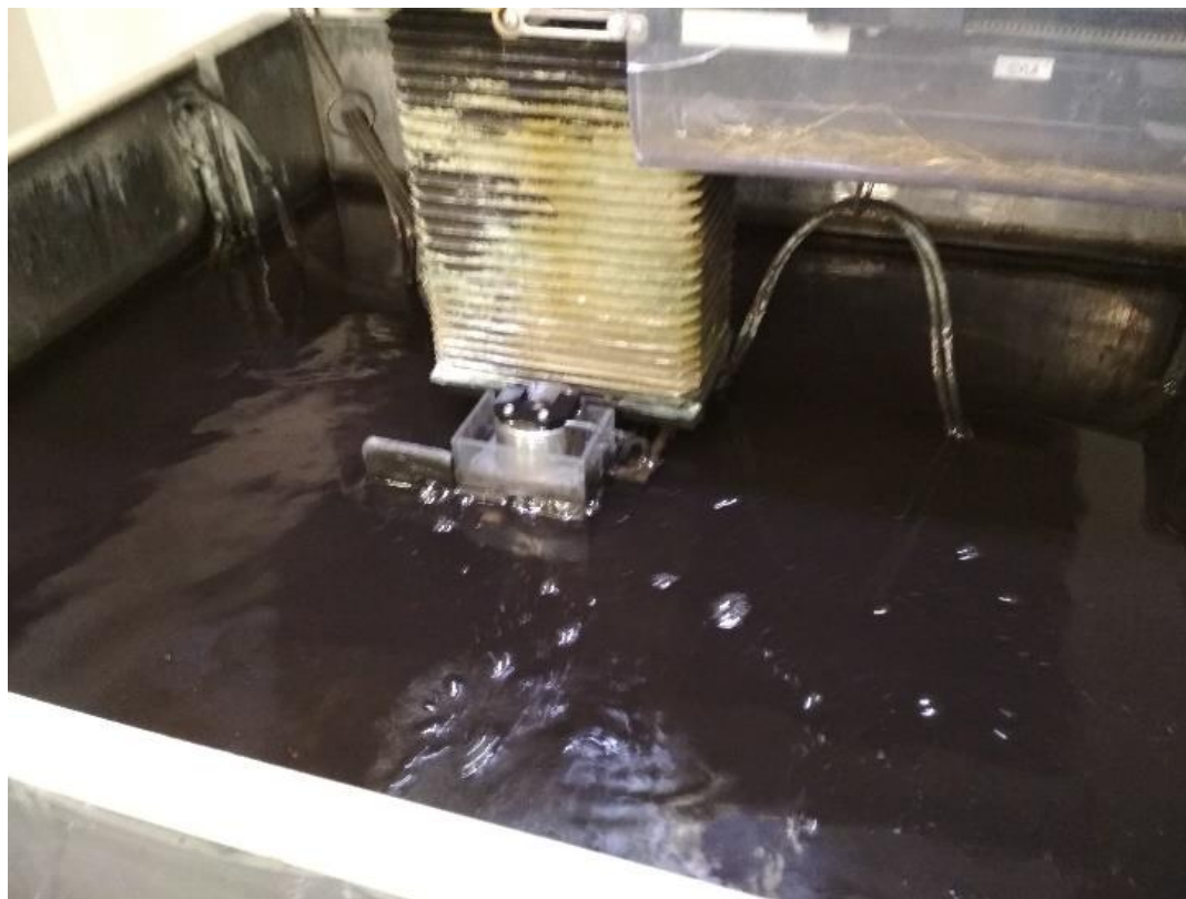
Obr. 31 WEDM, pohled do lázně dielektrika.
