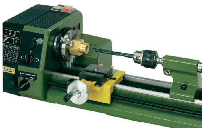
Obr. 20 Vrtání na soustruhu [18].
