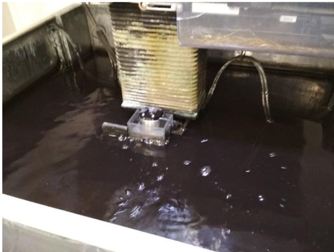
Obr. 31 WEDM, pohled do lázně dielektrika.
