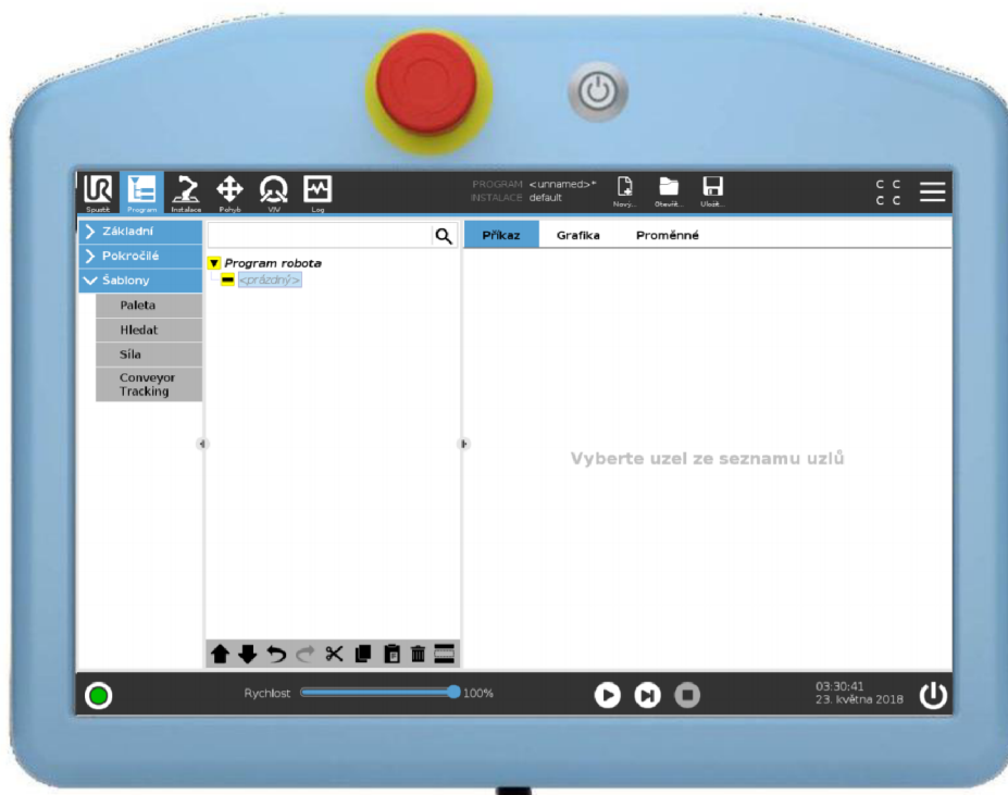
Obrázek 7 - Ovládací panel pro UR5 [13,14]
