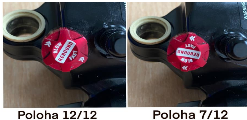
Obrázek 20 - Nastavení odskoku tlumiče [archiv autora]
