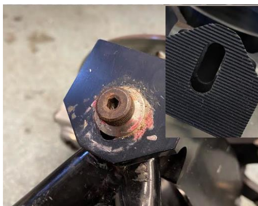
Obrázek 24 - Uzpůsobení těhlice pro nastavení odklonu kola [archiv autora]
