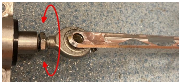
Obrázek 25 - Princip nastavení sbíhavosti předních kol vytočením sférického kloubku [archiv autora]
