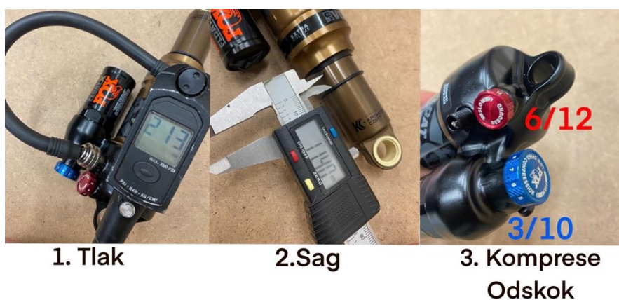
Obrázek 21 - Postup nastavení pravého zadního tlumiče [archiv autora]
