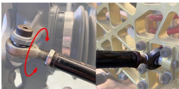
Obrázek 26 - Princip nastavení sbíhavosti zadních kol [archiv autora]
