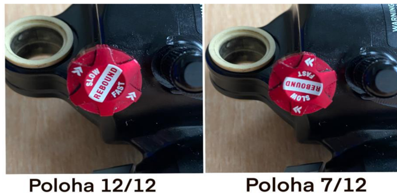
Obrázek 20 - Nastavení odskoku tlumiče [archiv autora]
