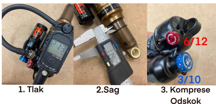
Obrázek 21 - Postup nastavení pravého zadního tlumiče [archiv autora]
