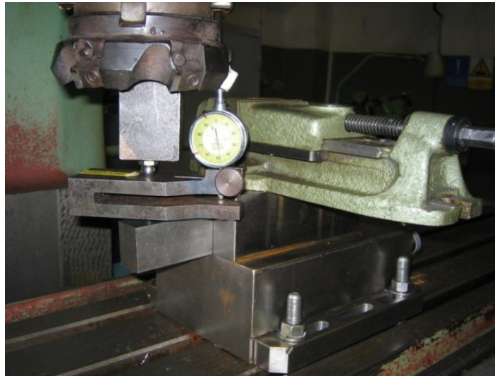
Obr. 2.11 Kalibrace dynamometru KISTLER pomocí mechanického dynamometru
