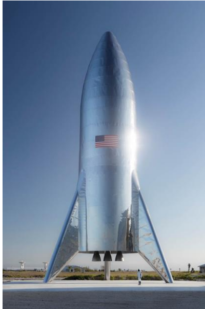
Obrázek 5.13: Prototyp Starship z nerezové oceli [86]
