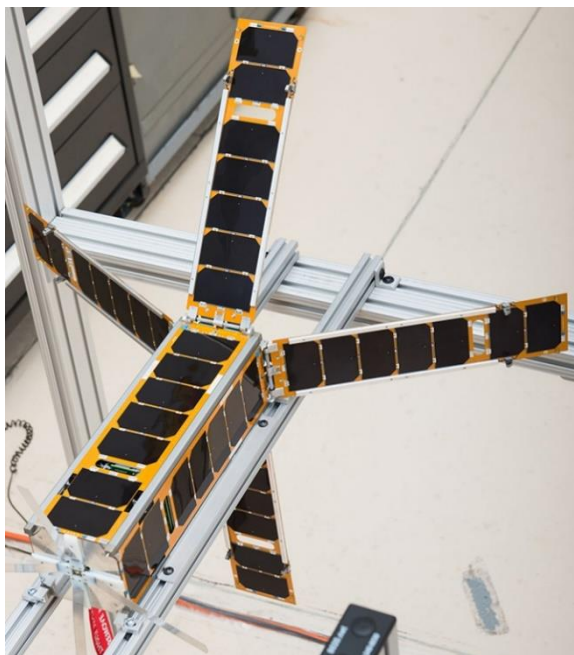
Obrázek 5.11: CubeSat s mechanismem ze slitiny s tvarovou pamětí [81]
