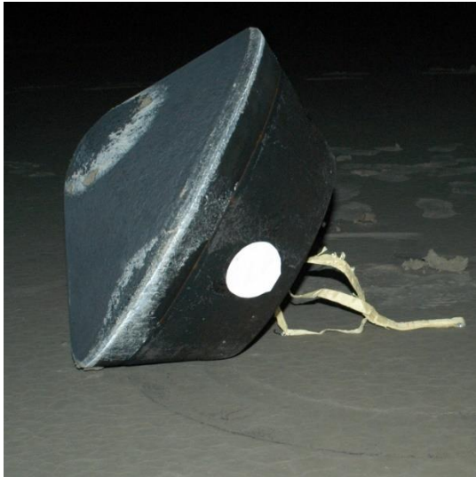
Obrázek 3.11: Návrátový modul zkoušející novou ablační ochranu PICA [125]
