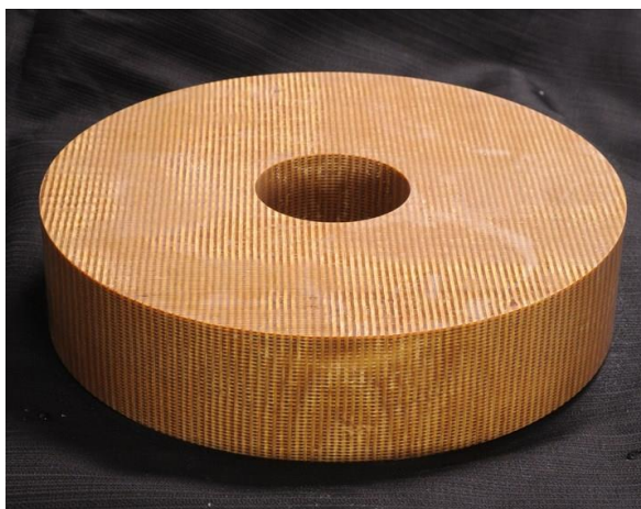
Obrázek 5.28: Podložky ze speciálního 3D tkaného křemenného materiálu [116]
