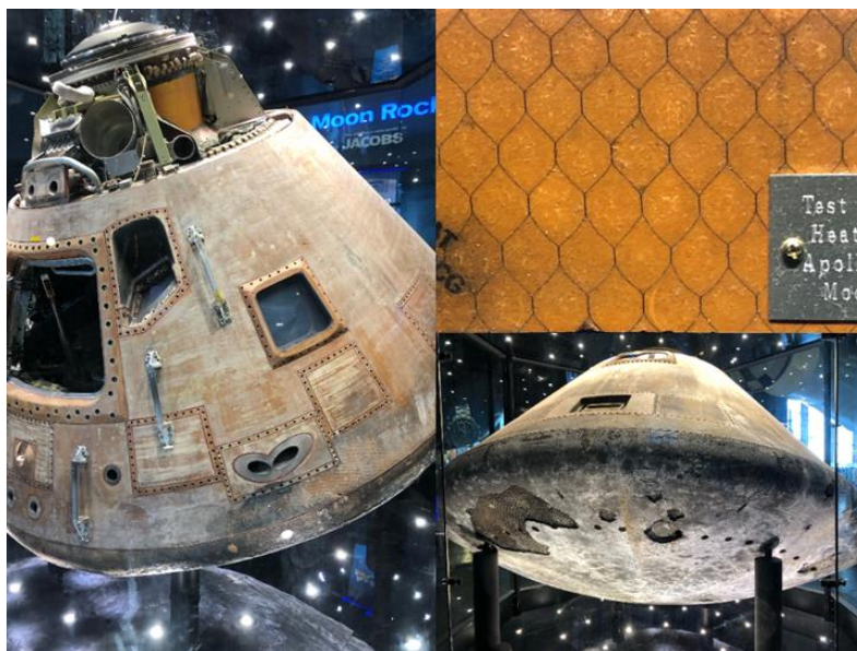
Obrázek 5.27: Tepelný štít modulu Apollo [116]
