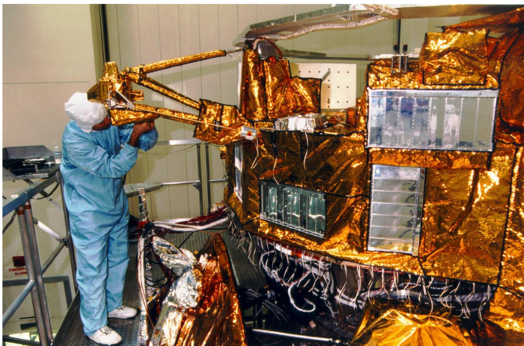
Obrázek 3.2: Sonda Cassini obalená ochrannou pokrývkou [42]
