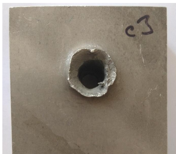
Obrázek 7.7: Výstup po střele v tlustém duralovém vzorku
