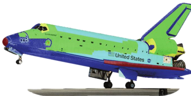
Obrázek 5.32: Izolace z RCC na raketoplánu [132]
