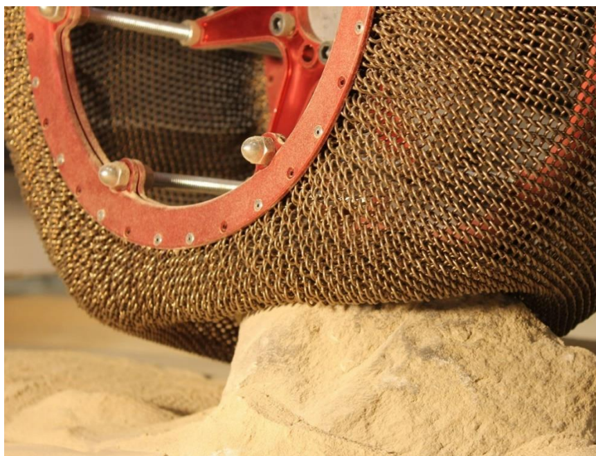
Obrázek 5.10: Pneumatika ze slitiny na bázi titanu a niklu [80]
