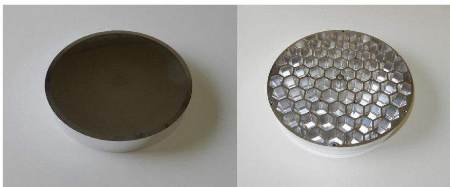
Obrázek 5.12: Zrcadlo ze slitiny hořčíku [72]
