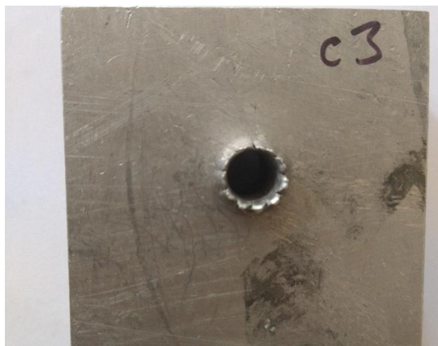
Obrázek 7.6: Vstup po střele v tlustém duralovém vzorku
