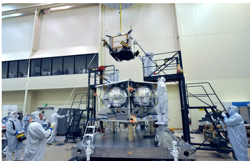
Obrázek 5.8: Obal elektroniky sondy Juno ze slitiny titanu [69]
