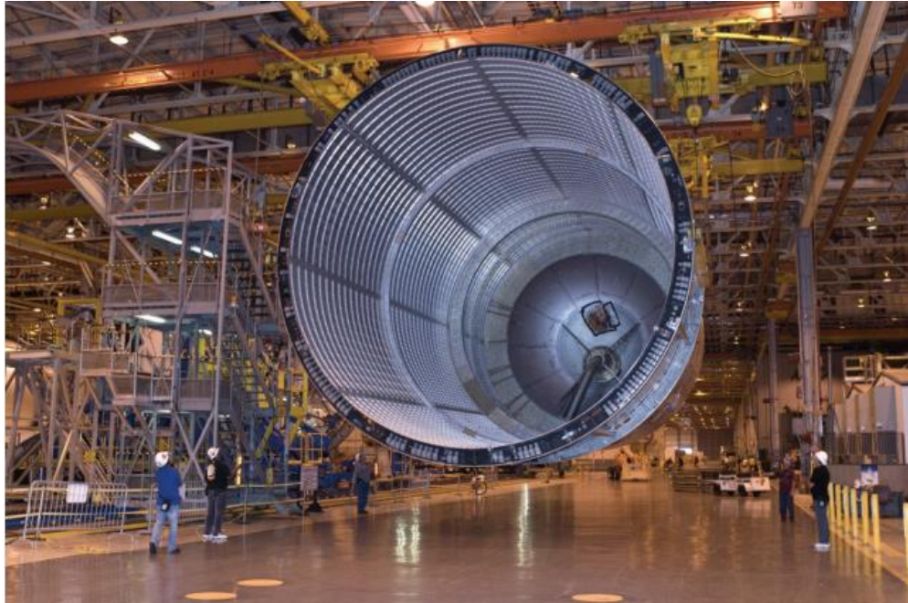
Obrázek 5.6: Nádrž na tekutý vodík, která je součástí externí nádrže u raketoplánu, z Al 2195 [54]
