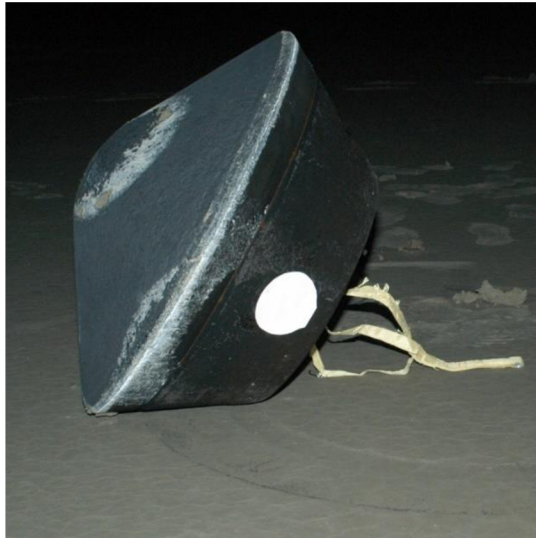
Obrázek 3.11: Návratový modul zkoušející novou ablační ochranu PICA [125]
