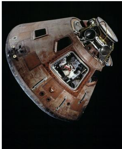
Obrázek 5.14: Apollo velitelský modul jehož vnější konstrukce a tepelný štít byli vyrobeny z nerezové oceli [87]
