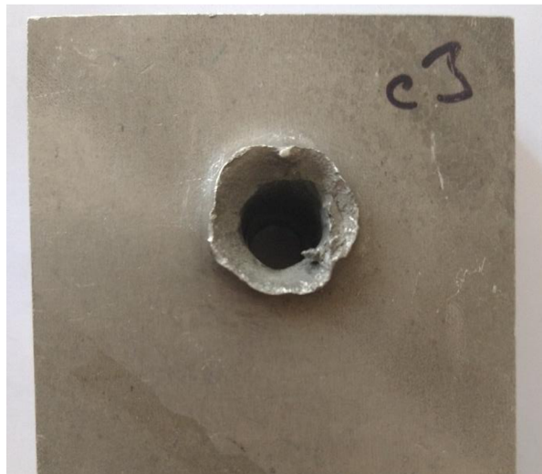
Obrázek 7.7: Výstup po střele v tlustém duralovém vzorku
