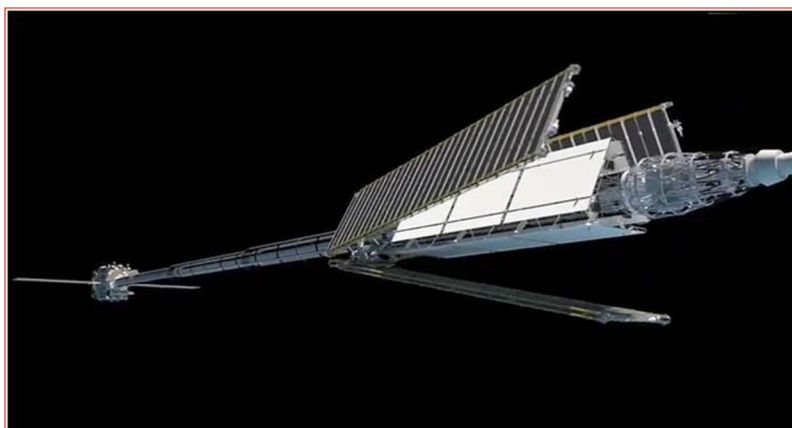
Obrázek 1.6: Návrh kosmického tahače s jaderným zdrojem energie [21]
