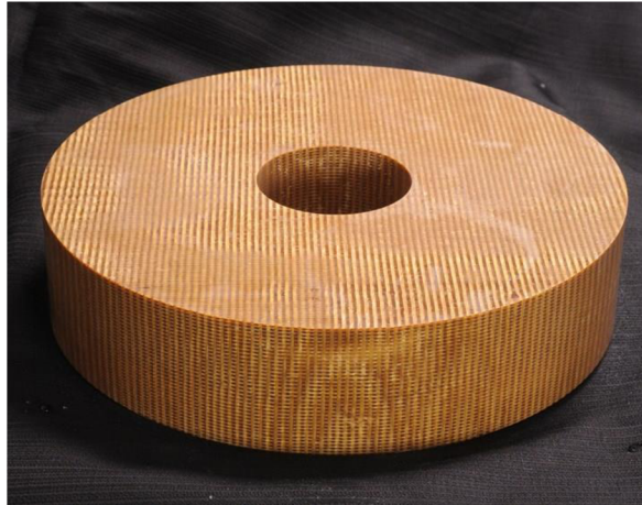
Obrázek 5.28: Podložky ze speciálního 3D tkaného křemenného materiálu [116]
