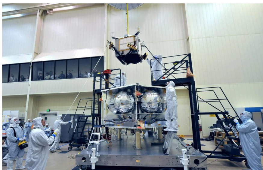
Obrázek 5.8: Obal elektroniky sondy Juno ze slitiny titanu [69]
