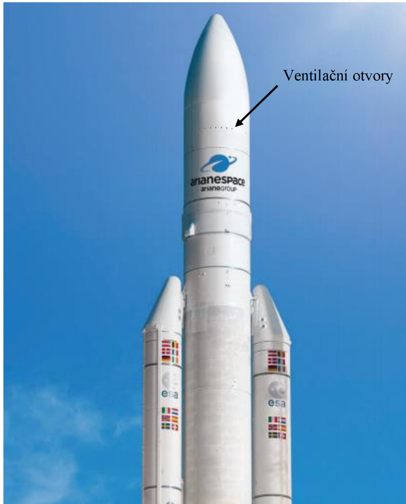
Obrázek 3.3: Ventilační otvory na nosné raketě Ariane 5 [33]
