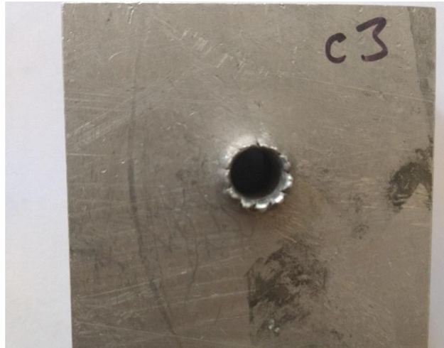
Obrázek 7.6: Vstup po střele v tlustém duralovém vzorku
