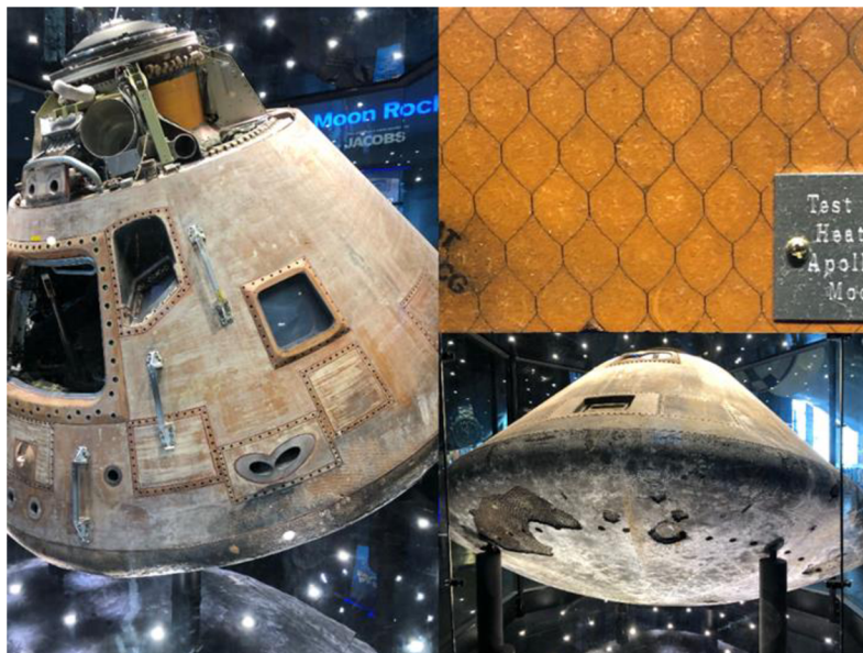
Obrázek 5.27: Tepelný štít modulu Apollo [116]
