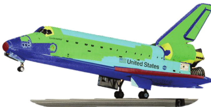
Obrázek 5.32: Izolace z RCC na raketoplánu [132]
