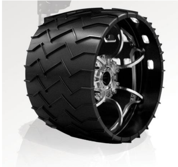
Obrázek 5.5: Kola roveru Curiosity ze slitiny hliníku a paprsky ze slitiny titanu [77]
