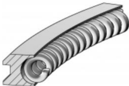
Obr. 19 Dvoudílný stírací kroužek s dvojitým zkosením [11]
