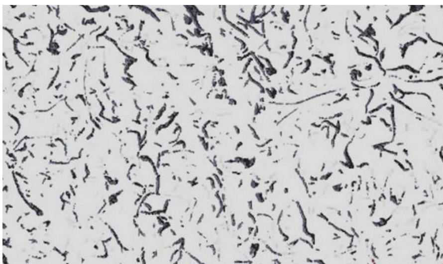
Obr. 27 Šedá litina, zvětšení 100 mikrometrů [9]
