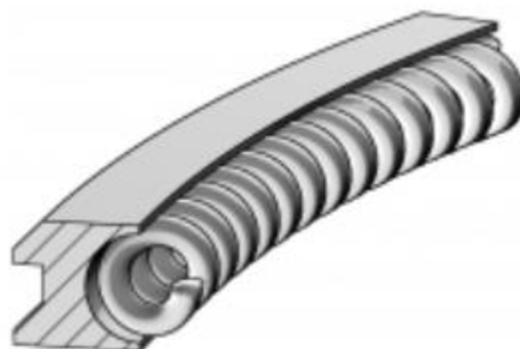
Obr. 19 Dvoudílný stírací kroužek s dvojným zkosením [11]
