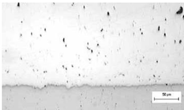
Obr. 32 Povrch chromového povlaku [13]
