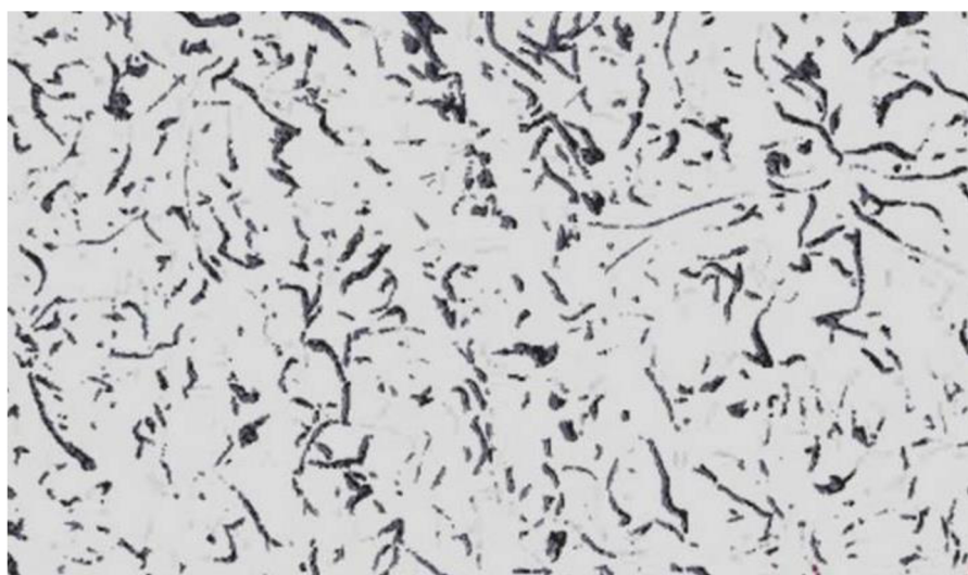
Obr. 27 Šedá litina, zvětšení 100 mikrometrů [9]
