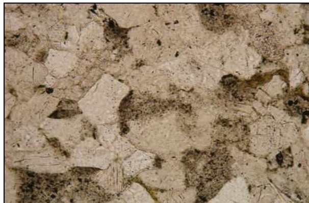
Obr. 63: Klast plagioklasu v pískovci 25-31-14 ze zlínské cihelny, vsetínské vrstvy zlínského souvrství, šířka snímku 0,8 mm. PPL.
