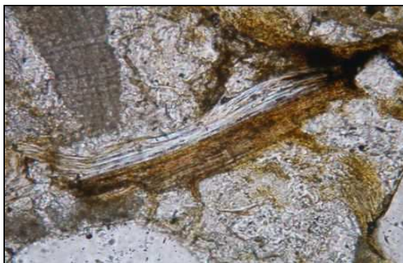
Obr. 39: Tabulka muskovitu s biotitem ve slepenci 25-31-54 z bývalého lomu u Hostišové, lukovské vrstvy, račanská jednotka, šířka snímku 0,4 mm. PPL.
