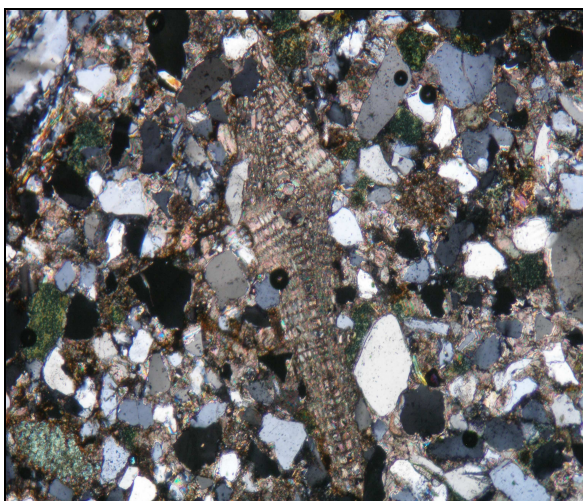
Obr. 86: Průřez orbitoidní foraminiferou (např. Discocyclina sp. nebo Lepidocyclina sp.), paleogén. V pískovci 25-43-10 z Brumova, bystrické vrstvy bystrické jednotky. Šířka snímku 2 mm XPL.
