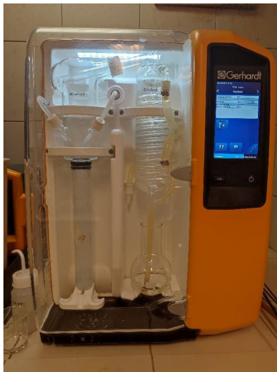
Obrázok 6 destilácia vzorky v destilačnom prístroji VAPODEST (foto. R.Martonová)
