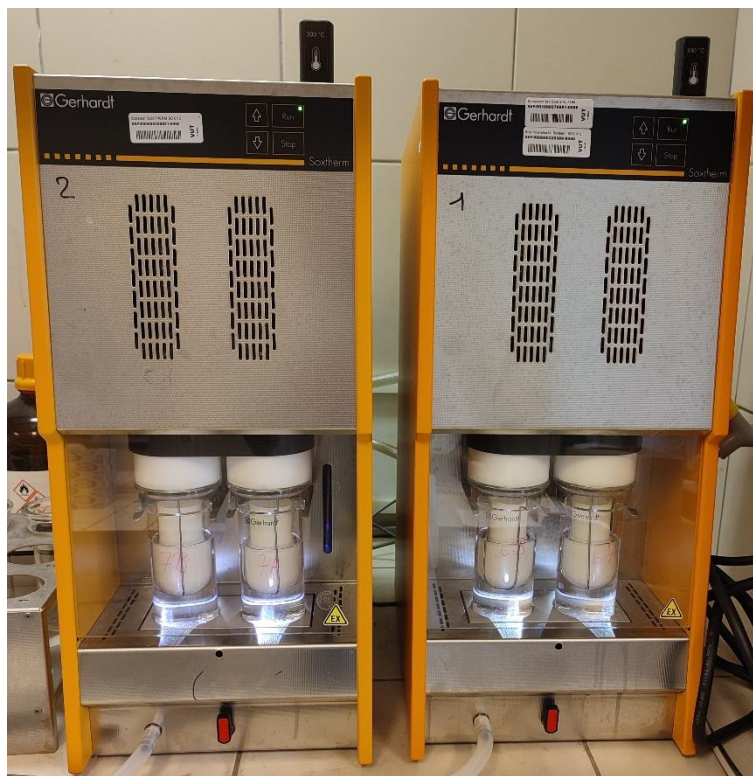
Obrázok 5 extrakcia tuku zo vzoriek v extraktore SOXTHERM (foto. R.Martonová)
