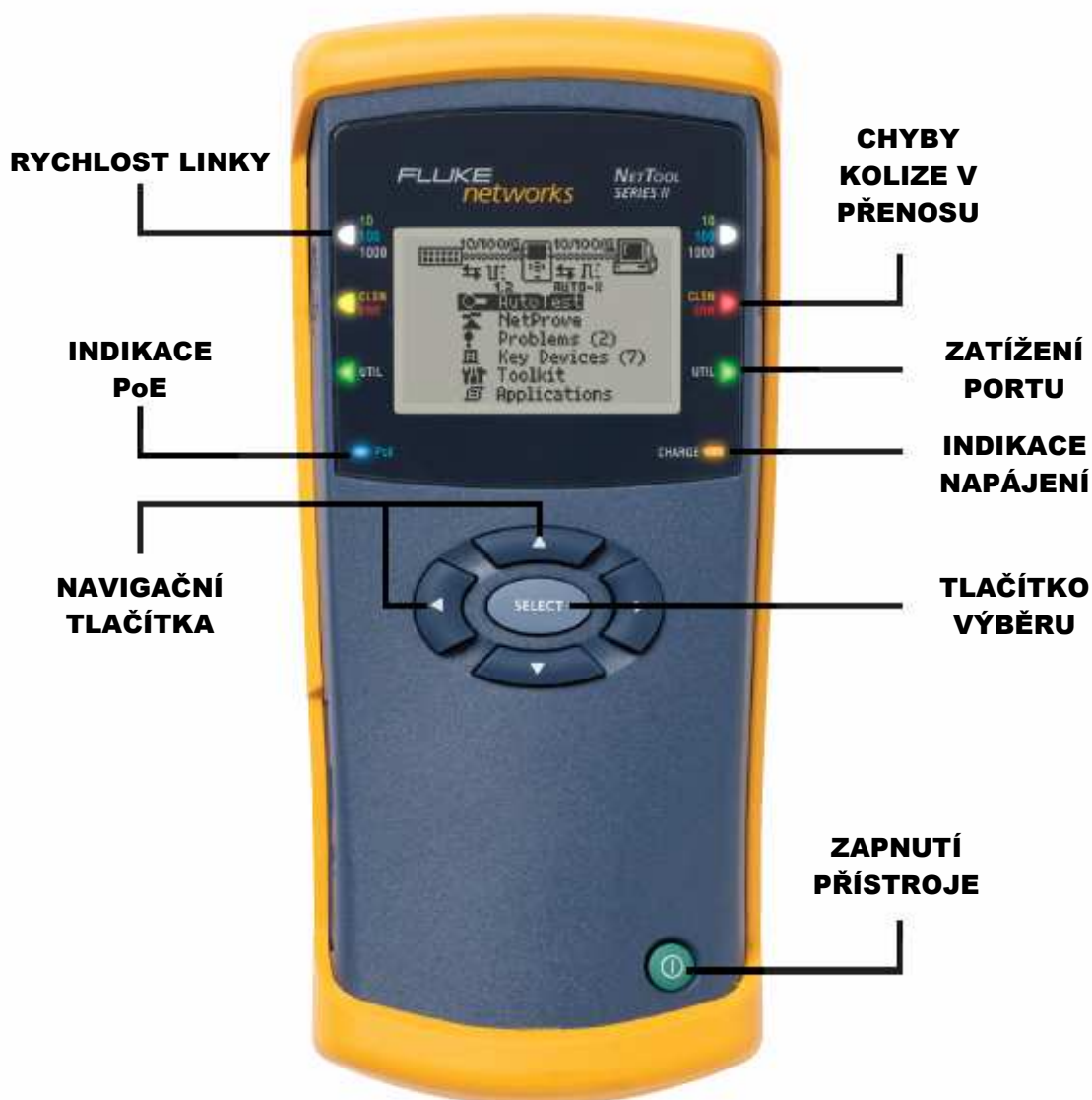
Obr. 6.1: Popis tlačítek a indikátorů NT analyzátoru
