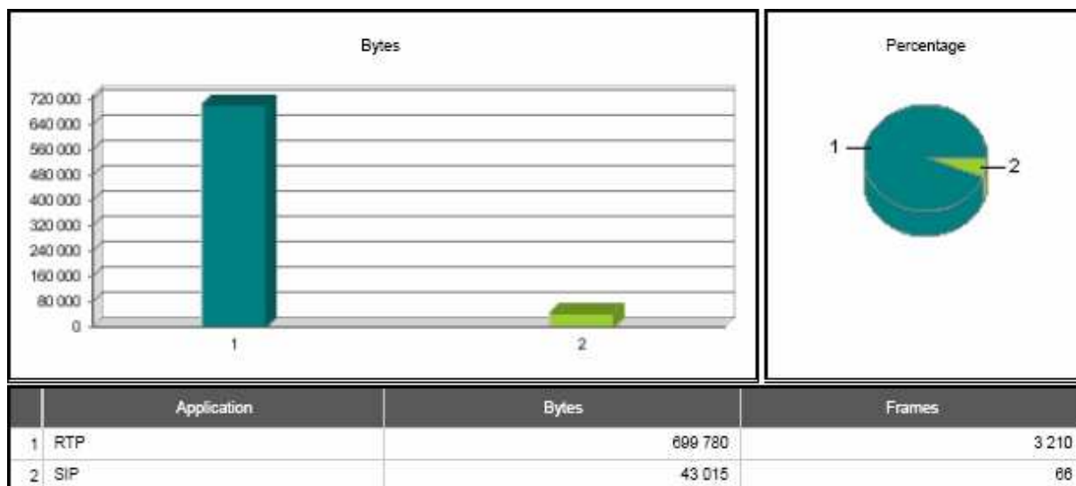
Obr. 4.5: Porovnání přenesených bytů během hovoru protokoly RTP a SIP
