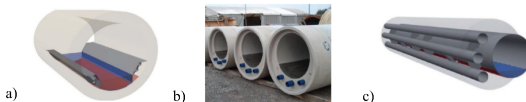
Obrázek 2.8: Typy nejpoužívanějších trubkových výměníků v kanalizačním potrubí :a) vložka s trubkovým výměníkem, b) trubkový výměník integrovaný ve stěně potrubí, c) dvouplášťový potrubní výměník [30].
