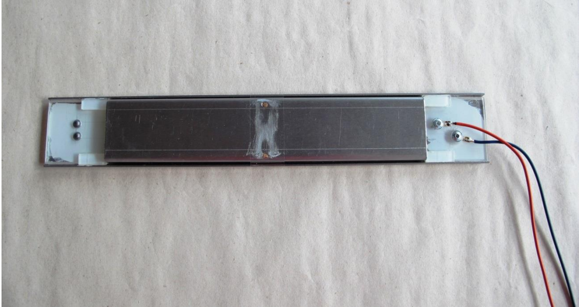
Obr. 3: Vnější konstrukce nikel-titanového snímače
