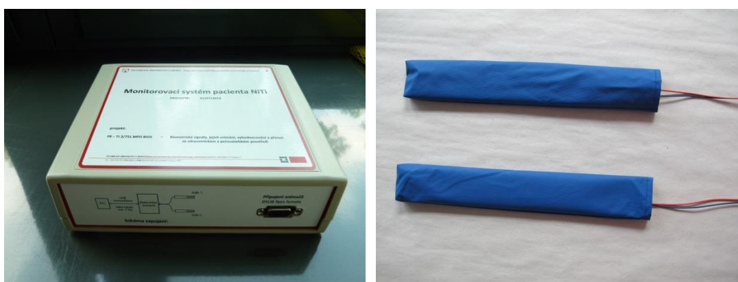
Obr. 2: Monitorovací systém pacienta ni-ti – vlevo je měřicí elektronika, vpravo jsou měřicí senzory
