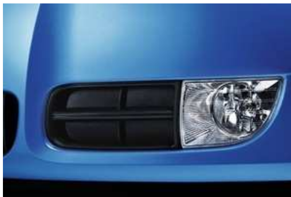
OBR.33: FUNKCE „CORNER“ ZABUDOVANÁ DO MLHOVÉHO SVĚTLOMETU ŠKODA [19]
