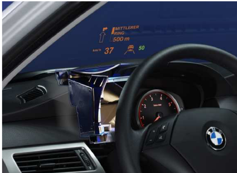
OBR.43 MOŽNÉ ROZLOŽENÍ PROTŘEBNÝCH PRVŮ HUD [31]
