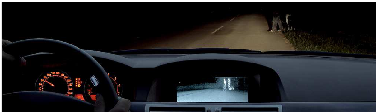
OBR.41:UKÁZKA NOČNÍHO VIDĚNÍ PODLE TECHNOLOGIE FIR [23]
