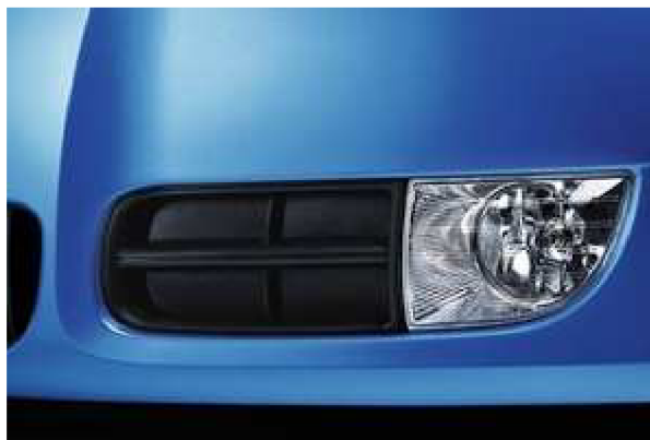
OBR.33: FUNKCE „CORNER“ ZABUDOVANÁ DO MLHOVÉHO SVĚTLOMETU ŠKODA [19]
