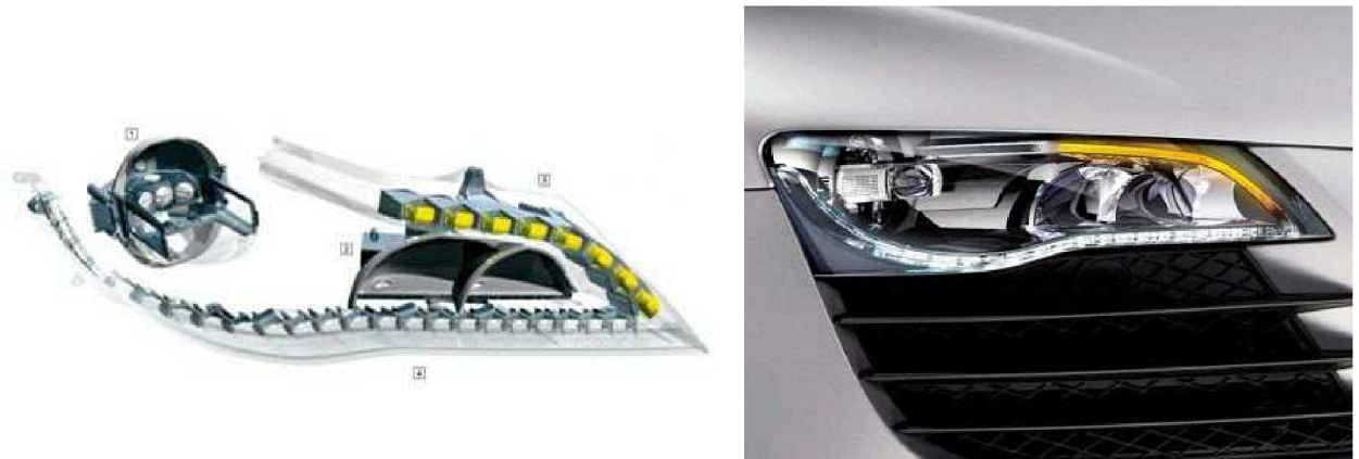
OBR. 15: KONCEPT POUŽITÍ LED DIOD SCHEMA (VLEVO), REÁLNÝ SVĚTLOMET (VLEVO) [11]
