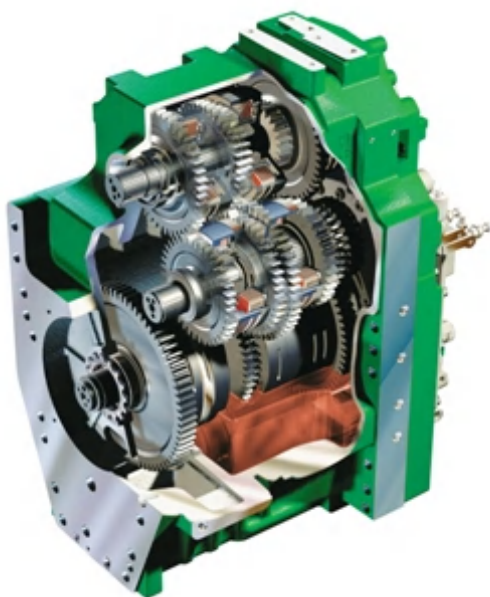
Obrázek 2 (vlevo): Převodovka Powershift v řezu
