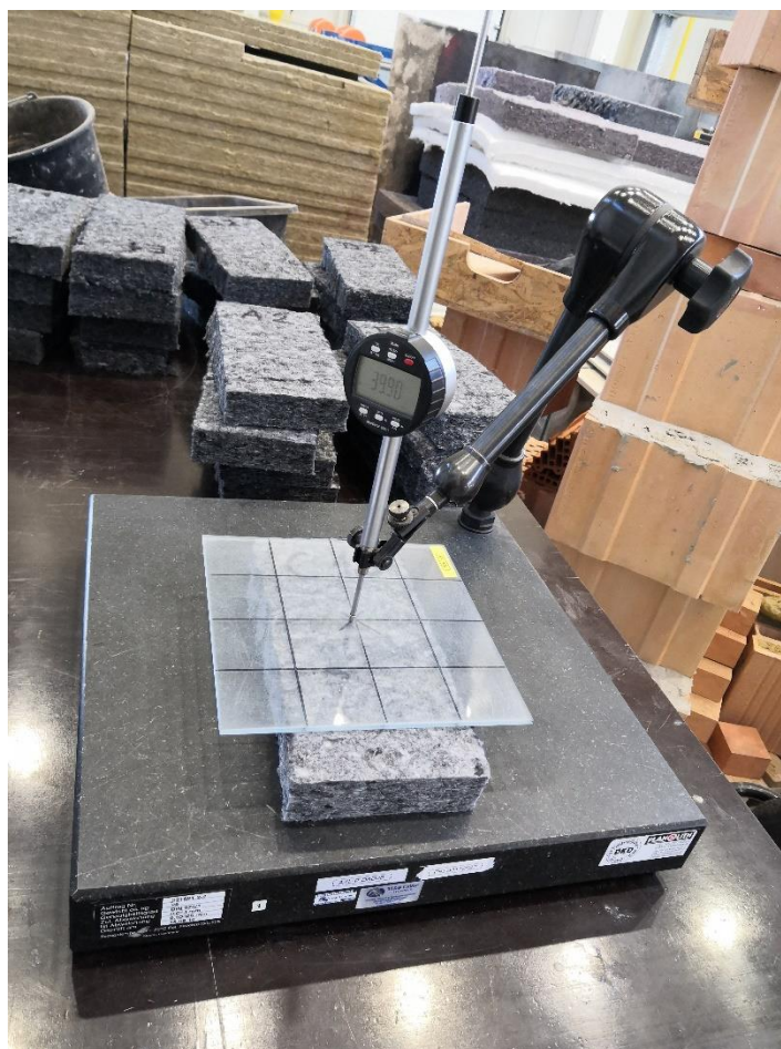
Obrázek 3: Digitální číselníkového úchylkoměru s dotykovou deskou pro měření tloušťky.
