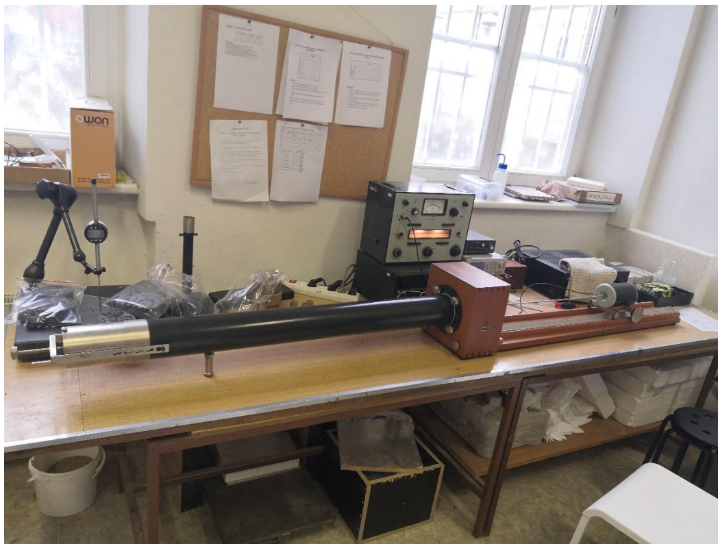
Obrázek 272: Kundtova trubice pro měření činitele zvukové pohltivosti.
