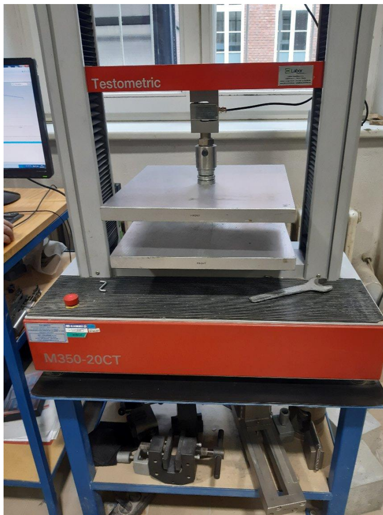
Obrázek 26: Zkušební lis pro měření stlačitelnosti.
