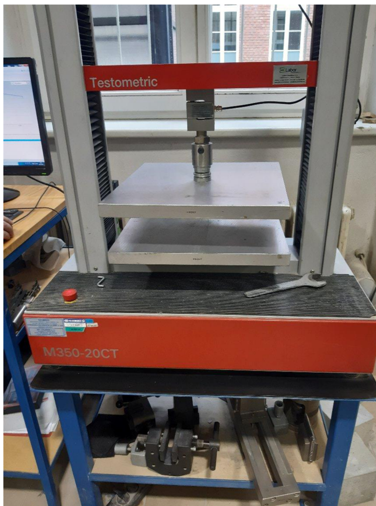
Obrázek 26: Zkušební lis pro měření stlačitelnosti.
