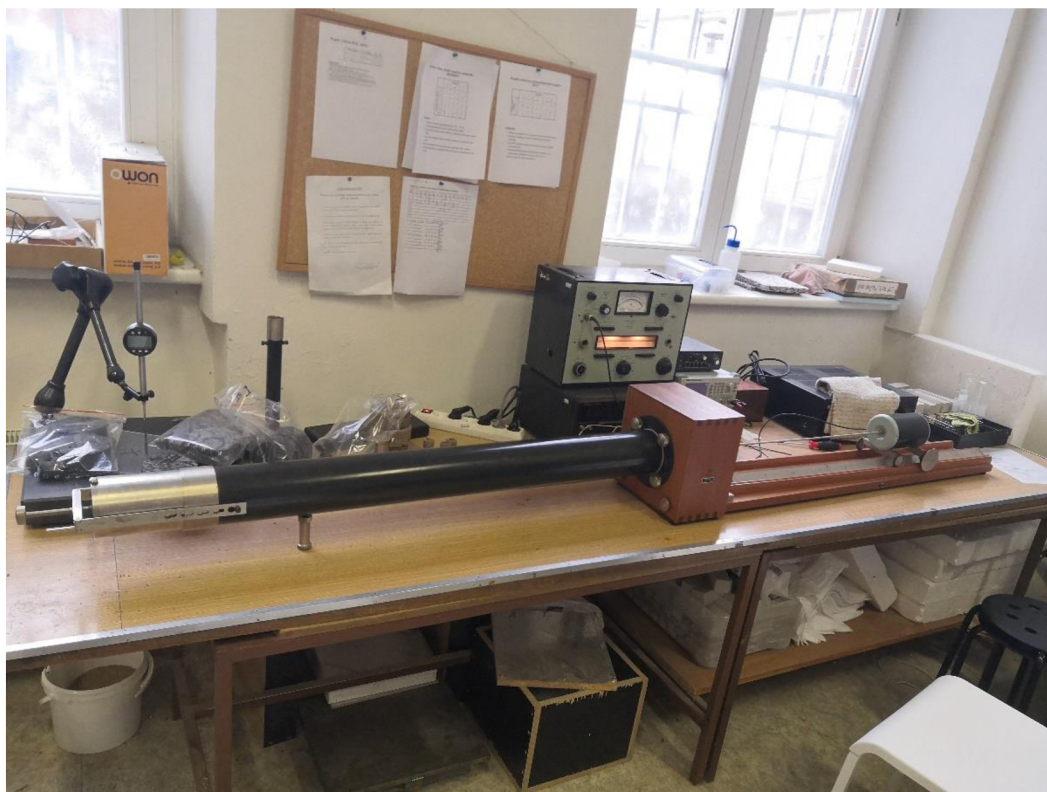
Obrázek 272: Kundtova trubice pro měření činitele zvukové pohltivosti.
